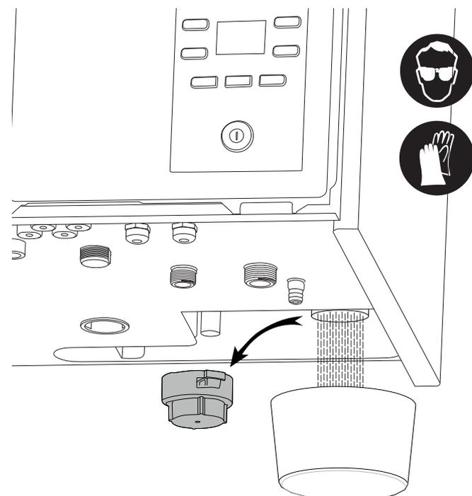
**B** Nettoyer l'entrée haute du siphon : par exemple utiliser un écouvillon pour atteindre l'entrée du siphon et décoller l'éventuel dépôt.
