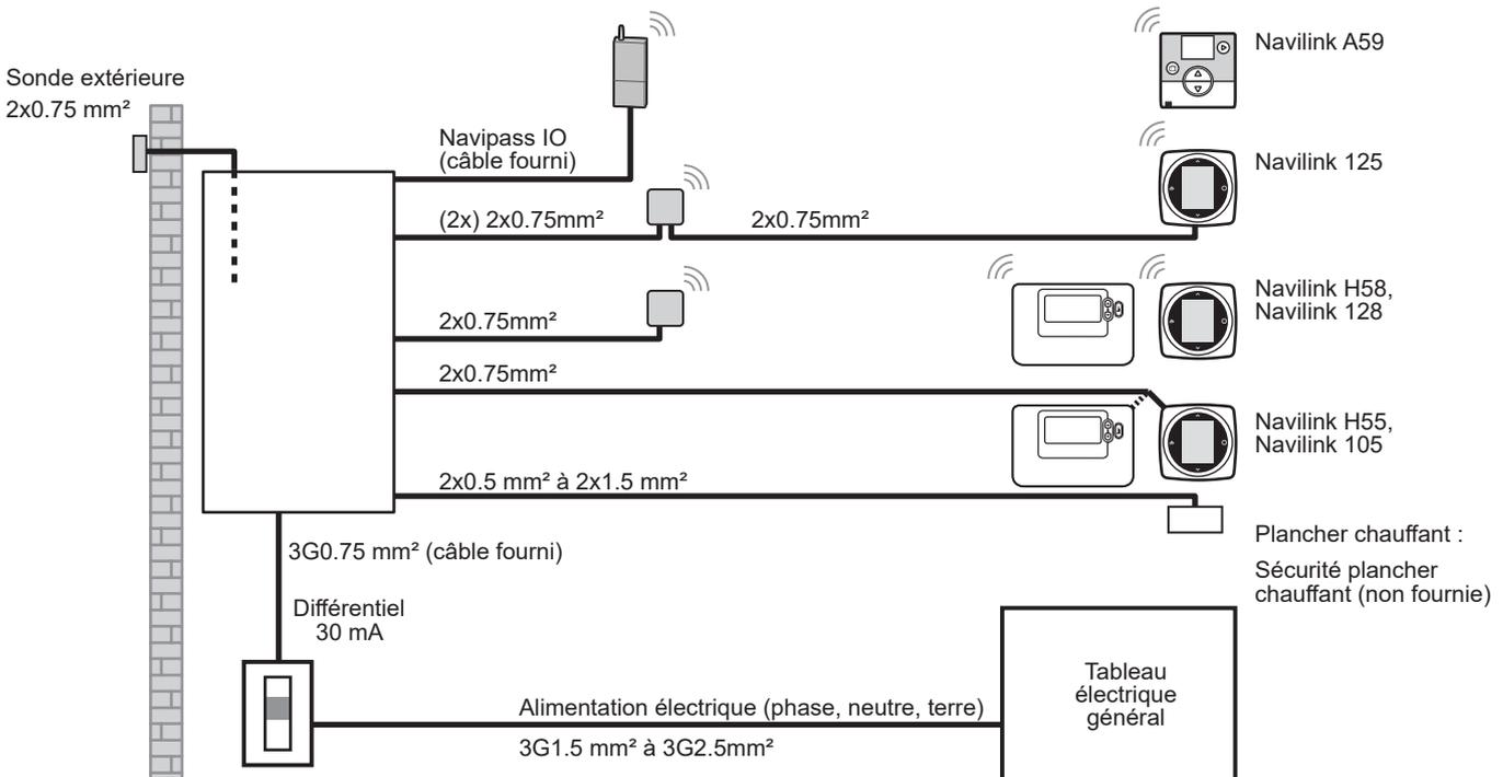
fig. 17 - Schéma d'ensemble des raccordements électriques
