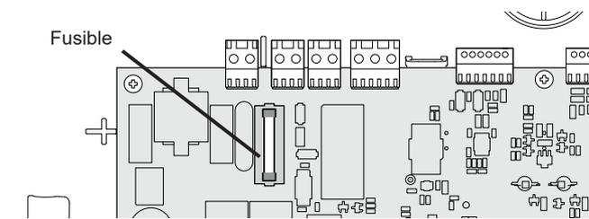
*fig. 32 - Remplacement du fusible*
