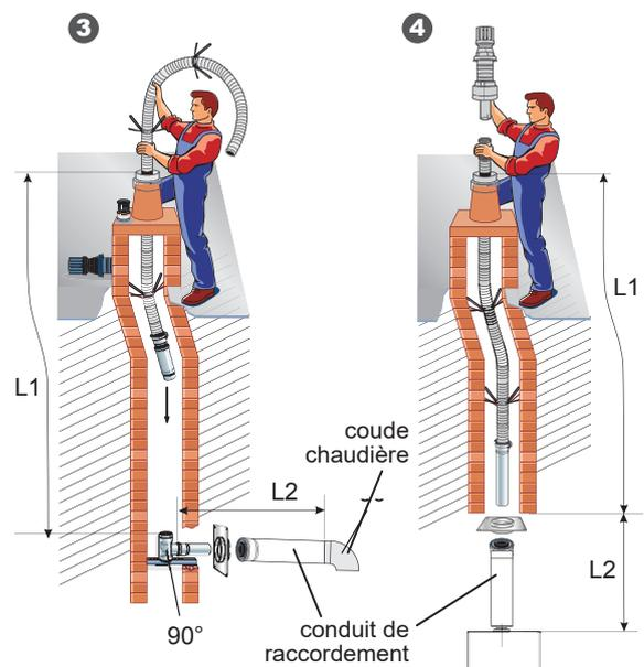
Système pour adaptation sur conduit d'évacuation existant (avec prise d'air dans la cheminée).
