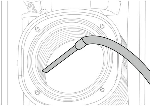
**D** Nettoyer le faisceau tubulaire de l'échangeur à l'aide d'une brosse synthétique. Nettoyer la chambre de combustion.
