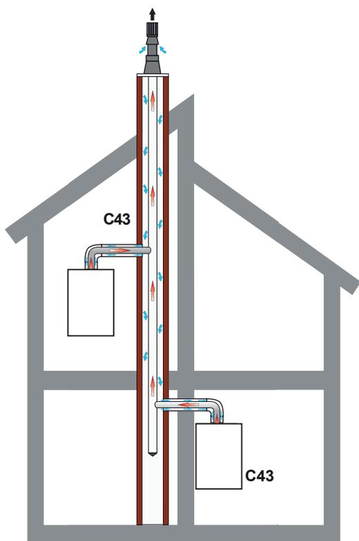
fig. 9 - Possibilités de raccordement (type 43)
