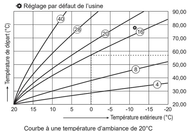
fig. 26 - Courbe de chauffe (Navilink H55)
