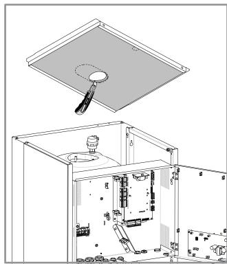
figure 4 - Découpe de la mousse isolante (modèle 1 service)
