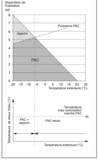
figure 2 - Exemple et limites de fonctionnement
