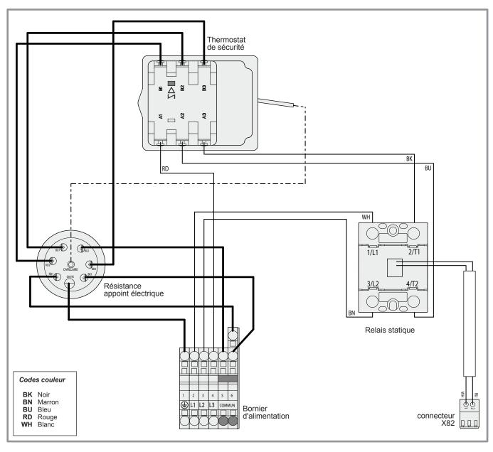
figure 7 - Câblage électrique du kit appoint électrique
