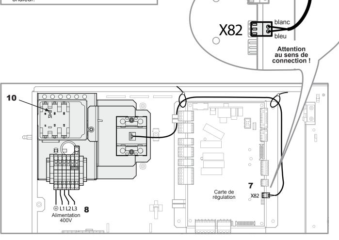
figure 6 - Raccordements électriques de l'appoint électrique
