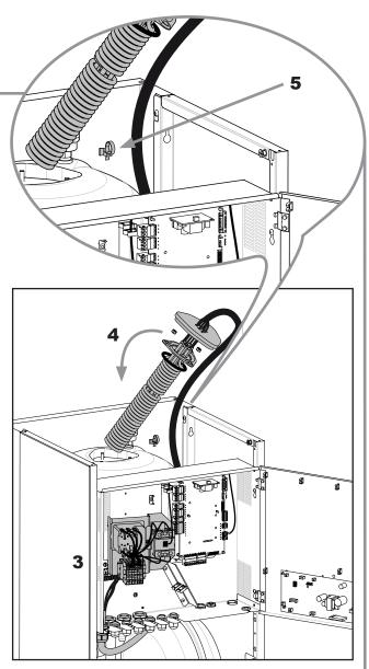
figure 5 - Montage du kit appoint électrique sur le module hydraulique (modèle 1 service)
