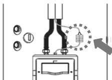
Le produit est livré pré-câblé sortie d'usine (longueur du câble 2m, 3X1,5mm<sup>2</sup>). Raccorder la câble d'alimentation de la régulation au réseau domestique monophasé ; alimentation permanente 230V~/50Hz (Terre, Neutre et Phase).
