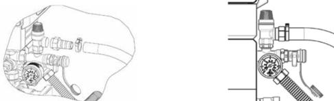
7. Le bidon de glycol (fourni) servira de réservoir de récupération pour le retour à la bâche une fois l'installation remplie et ne doit être en aucun cas relié aux eaux usées.
