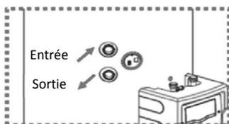
1. Retirer le bouchon du logement situé à côté de l'échangeur interne.
