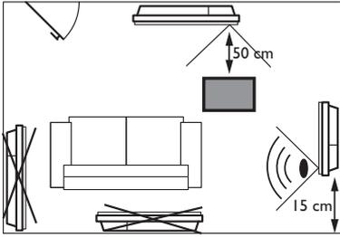
*Pour optimiser la détection d'absence de votre radiateur, évitez de l'installer dans un angle fermé ou derrière un meuble.*
