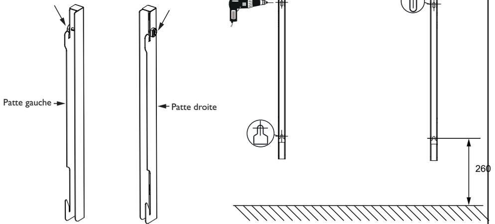
Positionnez le radiateur sur le crochet inférieur.
