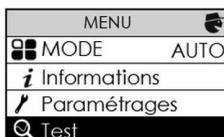
**Test :** Permet d'actionner les différents organes du chauffe-eau afin d'en vérifier le bon fonctionnement (pompe à chaleur, ventilateur, appoint électrique et vanne de dégivrage).
