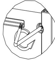
⑦ Retirez et conservez les deux vis de fixation de la partie arrière du boîtier de commande.
