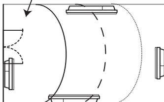
La fonction Fenêtre Ouverte est déconseillée dans les couloirs et dans les pièces situées à proximité d'une porte d'entrée donnant sur l'extérieur. Choisir l'emplacement le plus optimal
