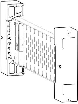
④ Positionnez le radiateur dans ses 2 cales, sur le côté opposé au boîtier.
