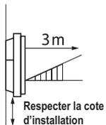
La détection se fait au dessus du capteur ( $\geq 40$  cm du sol)
