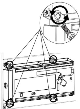
❶ Retirez et conservez les 4 vis de fixation situées à l'arrière du support du boîtier de commande.
