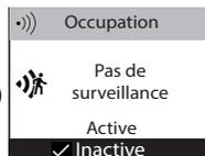
L'activation de la fonction détection d'occupation dans le Mode Prog, permet de gérer vos présences imprévues automatiquement.
