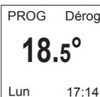
Vous pouvez modifier la température ECO, vous forcez donc le réglage par défaut entre la température Confort et la température Eco. «PROG Dérog.» s'affiche jusqu'à la prochaine plage Confort. Vous pouvez régler l'écart entre la température Confort et Eco dans le menu «Abais. T° ECO» (voir chapitre «Le menu en mode PROG»).
