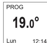
L'appareil fonctionne sur une plage Confort.
