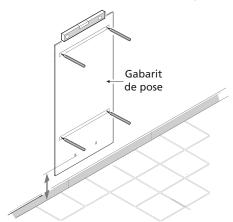
Percer puis cheviller votre chauffe-eau en utilisant des fixations de diamètre ( $\emptyset$ ) 10 mm minimum adaptées à votre mur (plaque de plâtre, béton, brique).
