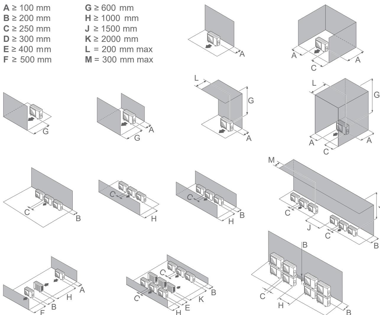
fig. 16 - Dégagements minimum d'installation autour de l'unité extérieure
