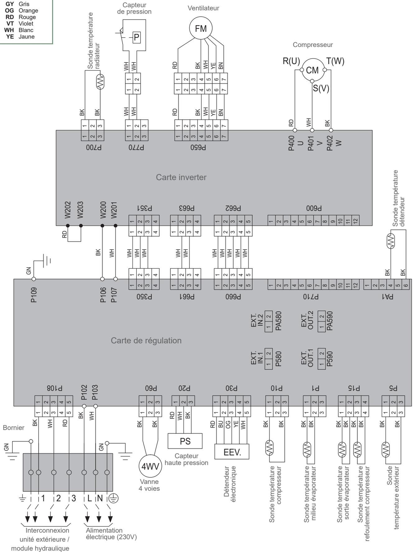
fig. 46 - Câblage électrique unité extérieure modèle 10
