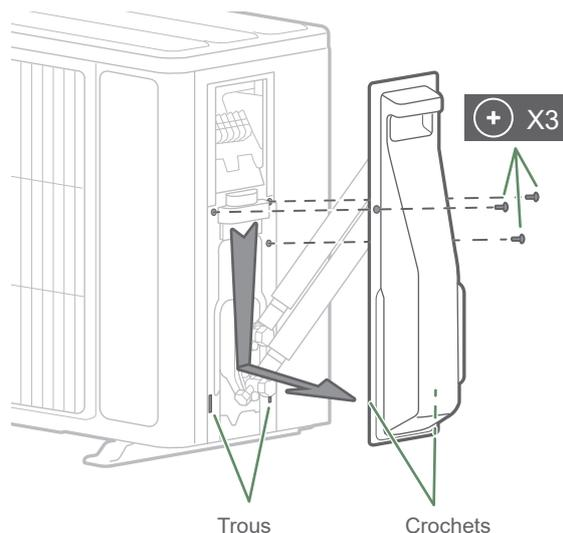
fig. 13 - Ouverture de l'unité extérieure modèles 5, 6 et 8
