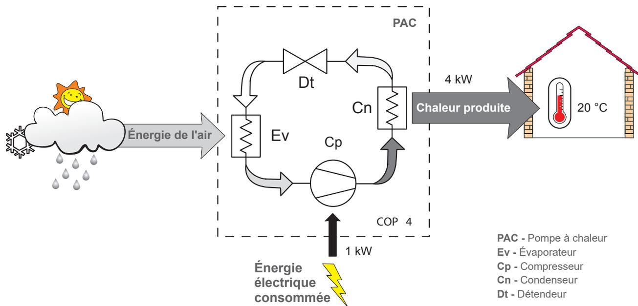
fig. 11 - Principe de fonctionnement d'une pompe à chaleur
