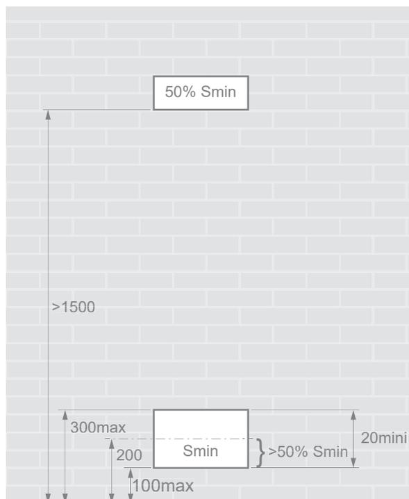
fig. 26 - Position des ouvertures pour la ventilation
