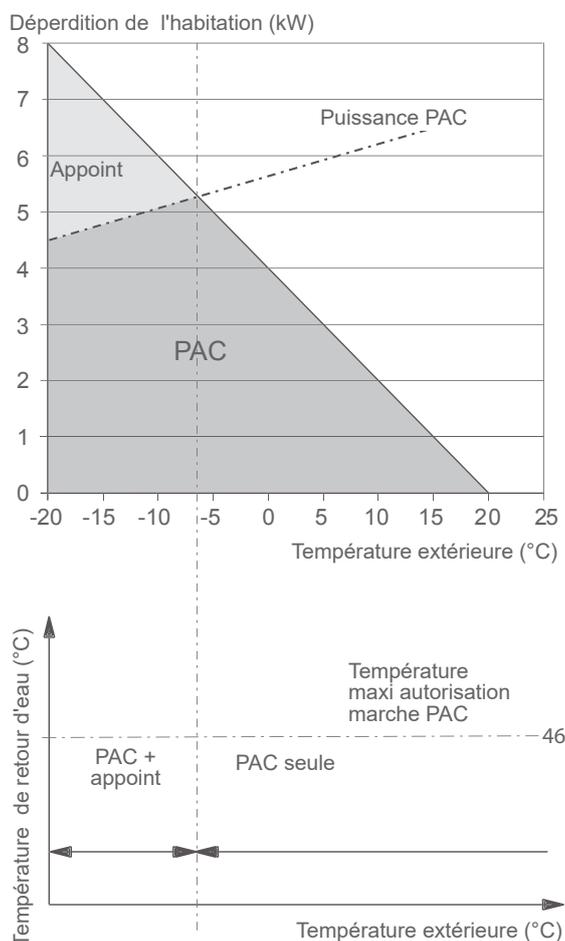
fig. 10 - Exemple et limites de fonctionnement
