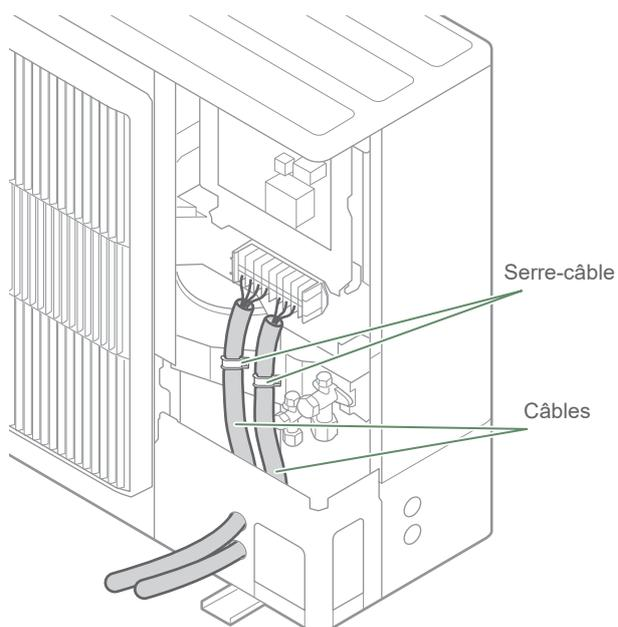
fig. 39 - Connexions au bornier de l'unité extérieure
