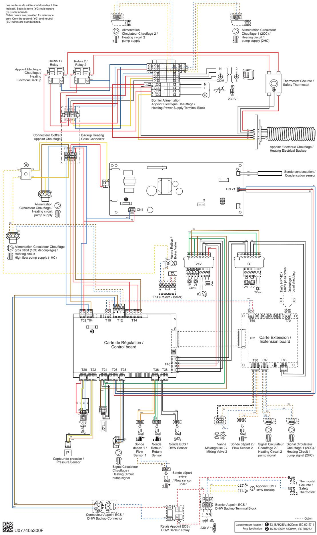
fig. 47 - Câblage électrique du Module Hydraulique
