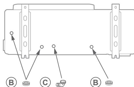
fig. 19 - Pose de l'unité extérieure, évacuation des condensats
