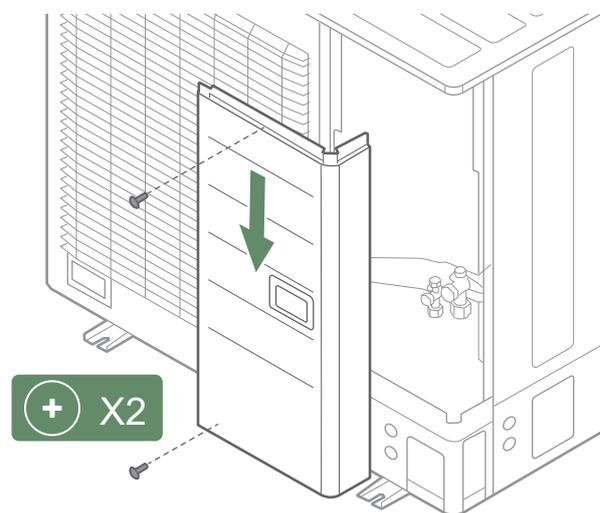
fig. 14 - Ouverture de l'unité extérieure modèle 10
