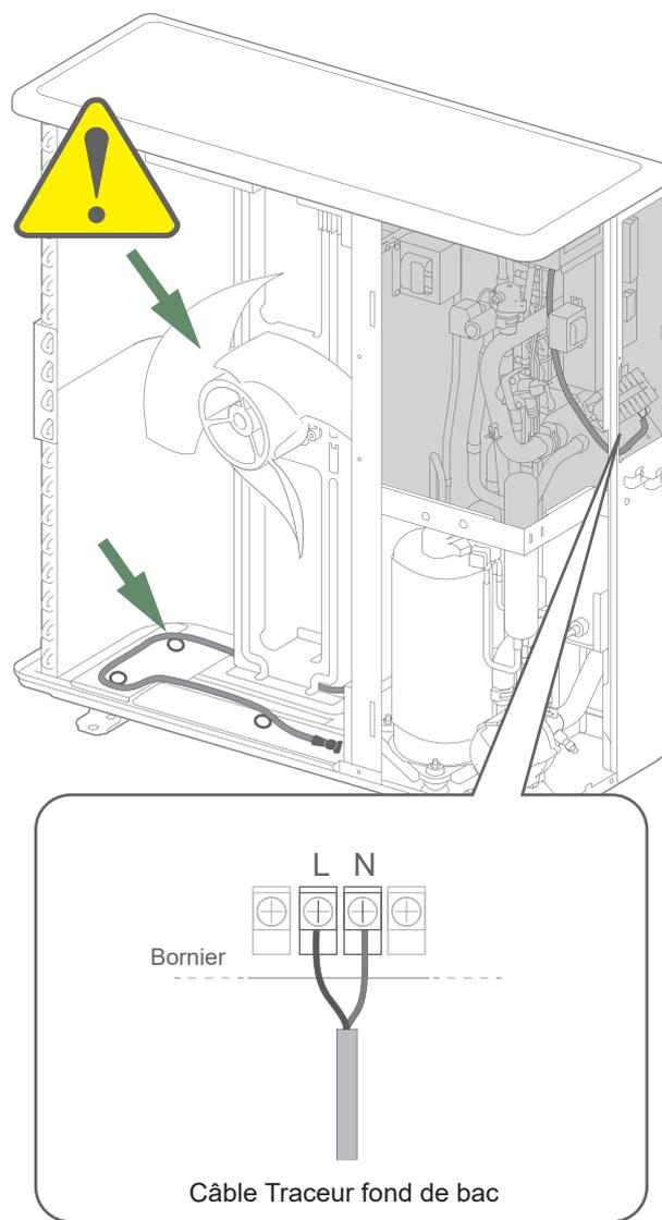
fig. 41 - Montage traceur fond de bac
