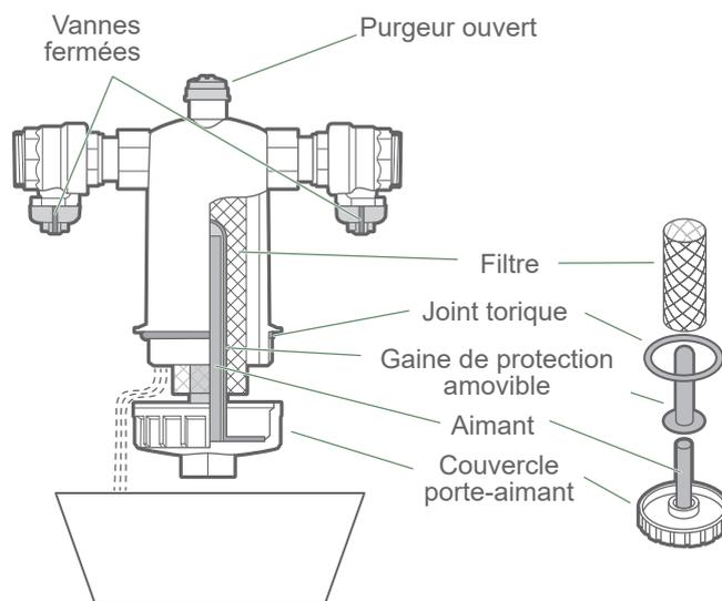
fig. 13 - Nettoyage du pot à boues
