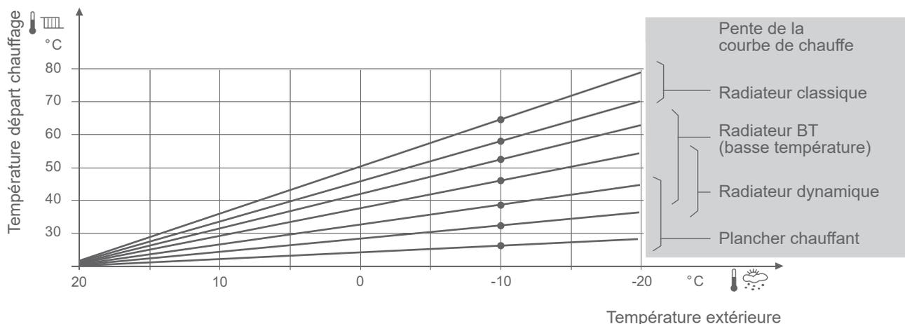
fig. 12 - Pente de la courbe de chauffe
