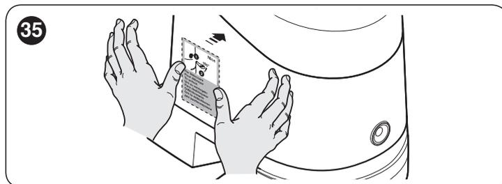
3. fixer sur le portail une plaque comportant au moins les données suivantes : type d'automatisme, nom et adresse du constructeur (responsable de la « mise en service »), numéro de série, année de construction et label « CE »
