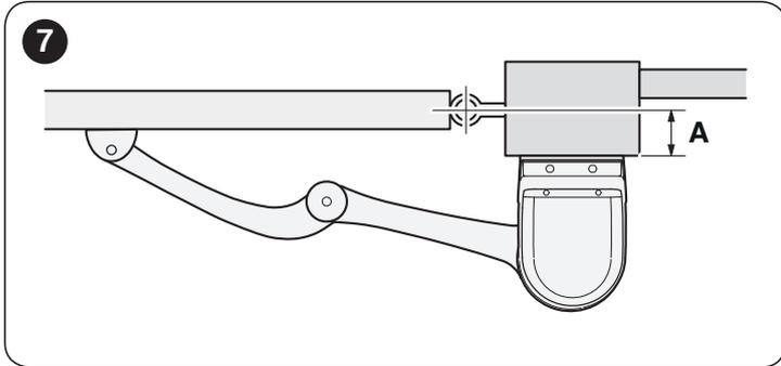
2. mettre le vantail dans la position d'ouverture maximale désirée et vérifier la valeur de l'angle d'ouverture qui en résulte
