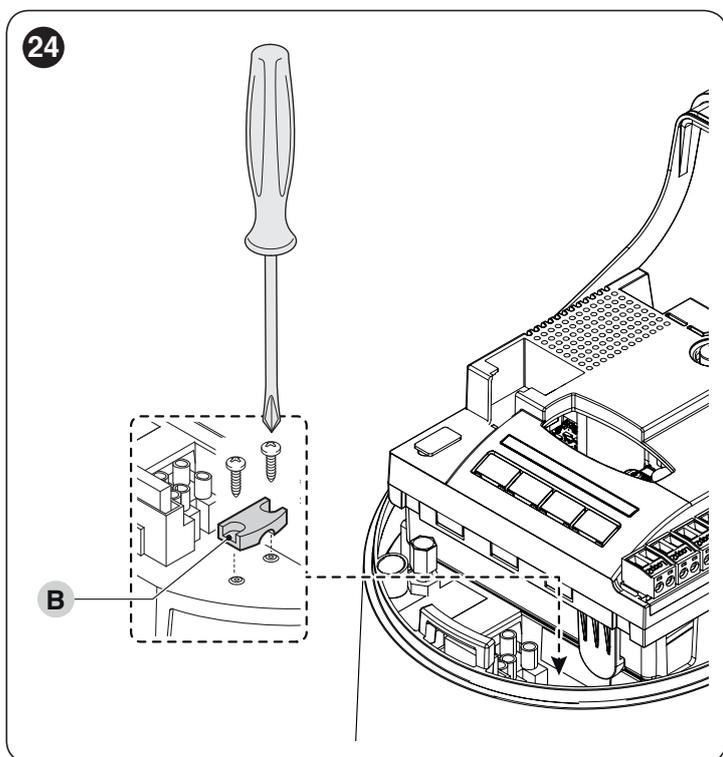
4. raccorder le câble d'alimentation (**C**) et le bloquer avec le serre-câble (**B**)
