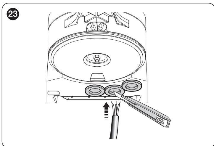
3. raccorder d'abord le câble d'alimentation du moteur avec centrale **HO7124**: dévisser le serre-câble (**B**)
