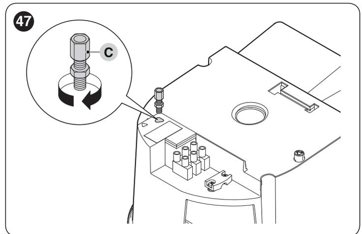
3. insérer le câble en acier (D) d'abord dans la vis (C), puis dans le trou (E) prévu à cet effet puis dans le trou du pivot (F)
