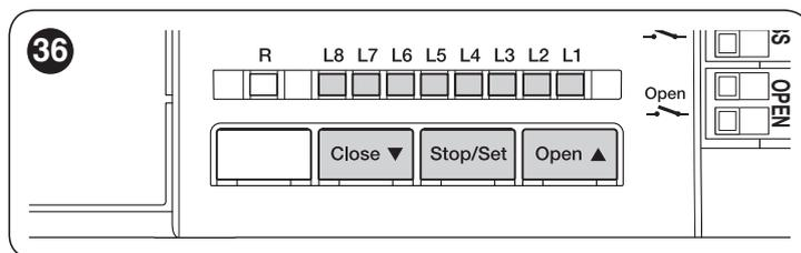
Les fonctions programmables disponibles sont installées sur **deux niveaux** et leur état de fonctionnement est signalé par huit led « **L1 ... L8** » présentes sur la centrale (led allumée = fonction active ; led éteinte = fonction non active).
