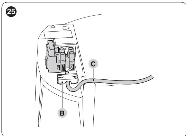
5. en utilisant la même procédure, raccorder le câble d'alimentation au moteur sans centrale **HO7224**
