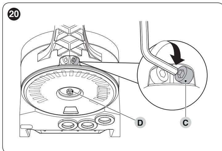
**Hand icon:** S'il n'y a pas dans l'installation de butée au sol au point de fermeture, il faut répéter toute la procédure également pour le réglage de la fin de course en fermeture
