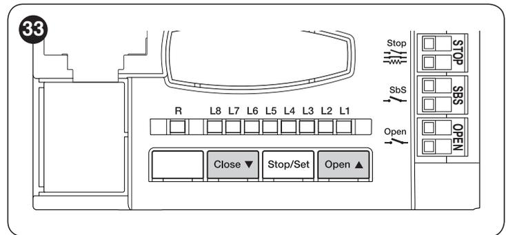
À la fin de la phase de reconnaissance, il est conseillé de faire réaliser à la centrale quelques manœuvres d'ouverture et de fermeture, de manière à vérifier le bon déplacement du portail et la présence d'éventuels défauts de montage et de réglage.
