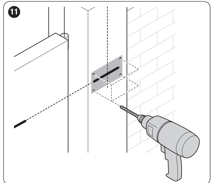
6. fixer l'étrier de fixation (C) du motoréducteur au mur en utilisant des chevilles, des vis et des rondelles adéquates (non fournies)
