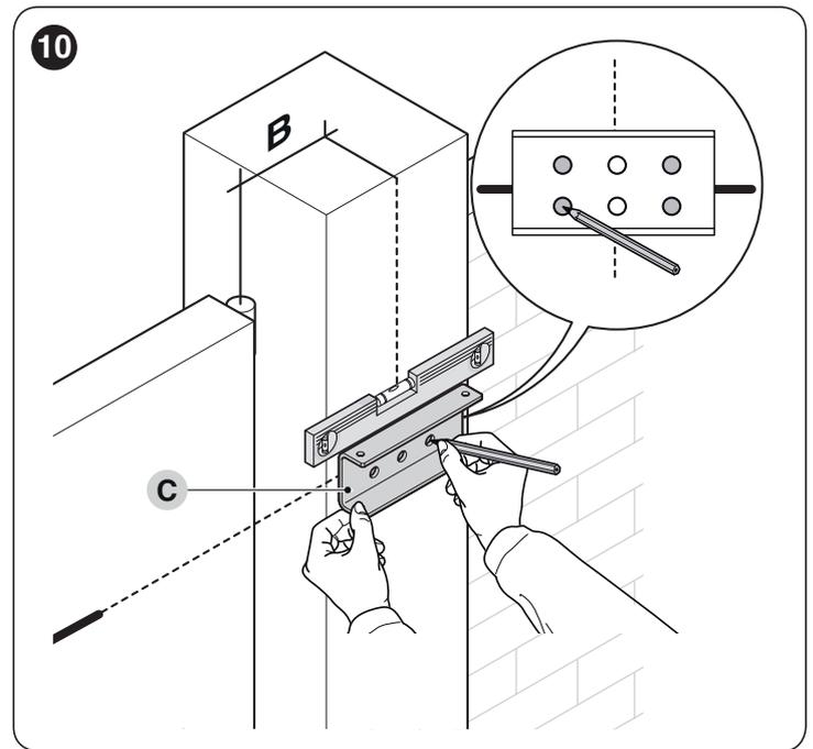
5. percer les trous au niveau des positions qui viennent d'être déterminées
