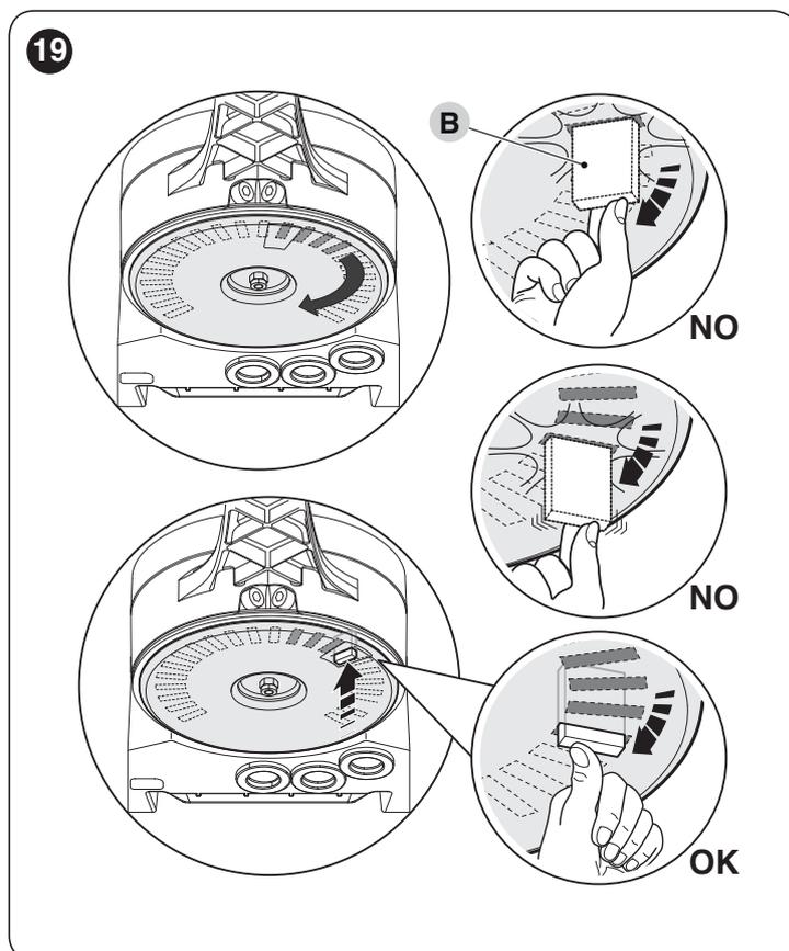
5. tourner le disque (A) de manière à ne pas faire tomber la fin de course et en amenant la fente dans la position illustrée sur la « **Figure 18** ». Pour un réglage plus précis, agir sur la vis de réglage (C)
