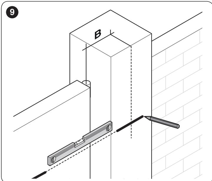
4. utiliser l'étrier de fixation (C), en position horizontale, en guise de gabarit pour déterminer la position des quatre trous de fixation
