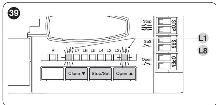
3. appuyer sur la touche **[Open ▲]** ou **[Close ▼]** pour déplacer la led clignotante sur « **L8** », c'est à dire la « led d'entrée » qui correspond au paramètre « **Liste anomalies** »
