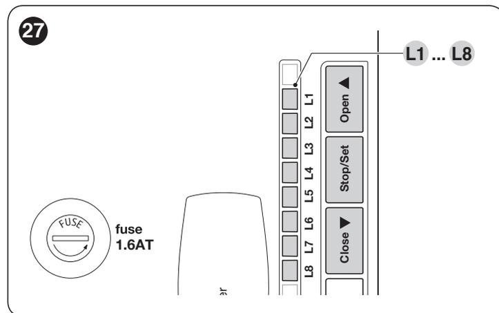
Les fonctions programmables disponibles sont installées sur **deux niveaux** et leur état de fonctionnement est signalé par huit led « L1 ... L8 » présentes sur la centrale (led allumée = fonction active ; led éteinte = fonction non active).
