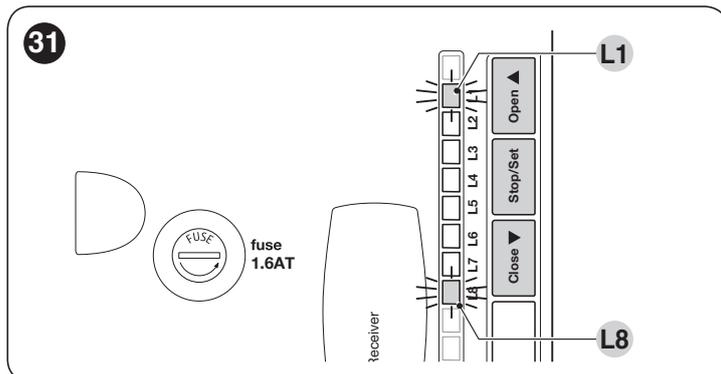
2. appuyer sur la touche **[Open ▲]** ou **[Close ▼]** pour déplacer la led clignotante sur « **L8** », c'est à dire la « led d'entrée » qui correspond au paramètre « **Liste anomalies** »
