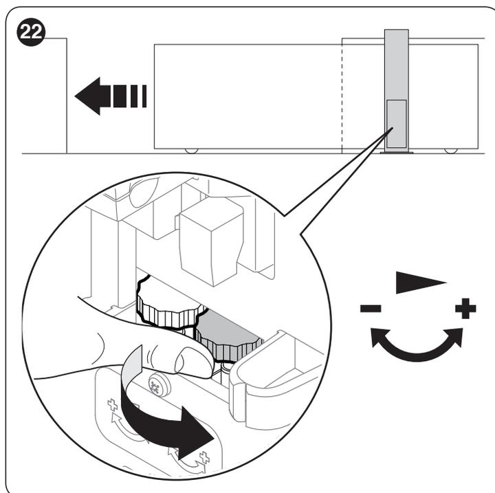
4. ensuite, sur la centrale, appuyer de nouveau sur la touche [Open ▲] ou [Close ▼] pour commander l'ouverture ou la fermeture du vantail pour enregistrer la nouvelle position. Si nécessaire, répéter l'opération jusqu'à ce que le vantail atteigne le fin de course voulu.
