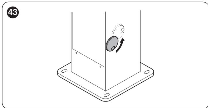
2. introduire la clé et la tourner dans le sens des aiguilles d'une montre
