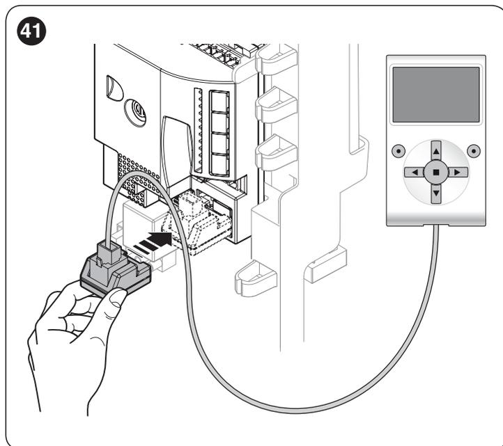
L'Oview peut être relié simultanément à plusieurs centrales (jusqu'à 5 sans précautions spéciales, jusqu'à 60 en respectant les recommandations y afférentes) et peut même rester branché à la centrale pendant le fonctionnement normal de l'automatisme. Dans ce cas, il peut être utilisé pour envoyer directement les commandes à la centrale en utilisant le menu « utilisateur ».
