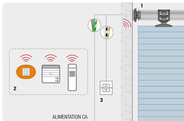
1. MOTEUR TUBULAIRE 2. ÉMETTEUR 3. BOUTON MONTÉE/DESCENTE RACCORDÉ AU TTBUS\* OU BOUTON-POUSSOIR AVEC ERA PLUS MH ET ERA PLUS LH
