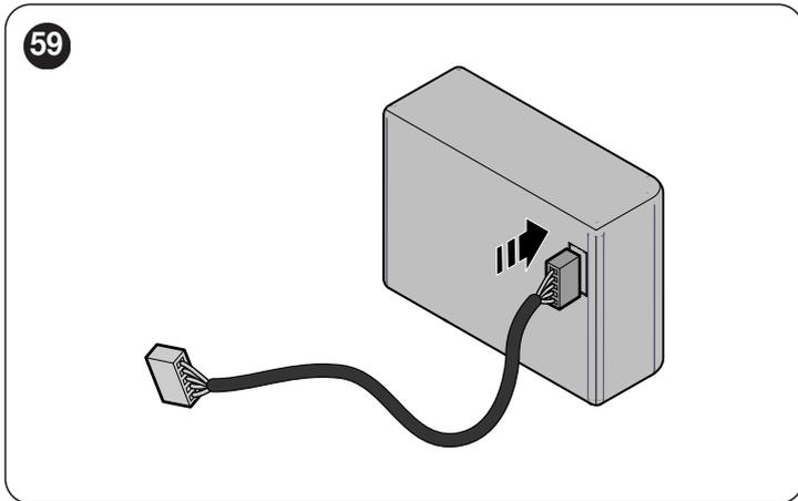
4. insérer le connecteur (C) correspondant sur la centrale de commande («**Figure 60**»)
