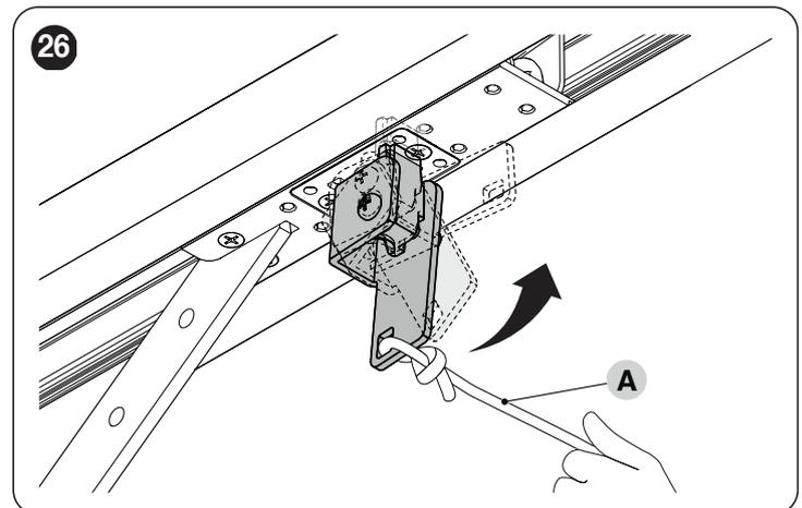
2. déplacer manuellement le portail afin d'aligner la partie inférieure du chariot moteur avec la partie supérieure et permettre de le placer dans son logement.
