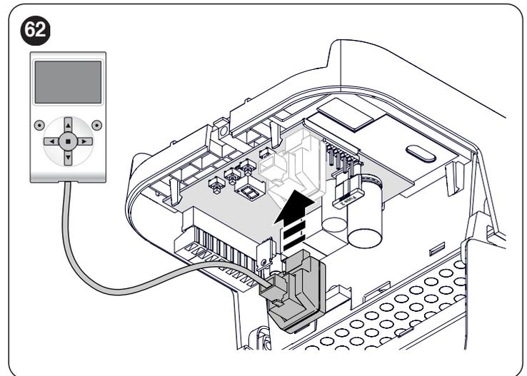
L'Oview peut être relié simultanément à plusieurs centrales (jusqu'à 16 sans précautions spéciales) et peut même rester branché à la centrale pendant le fonctionnement normal de l'automatisme. Dans ce cas, il peut être utilisé pour envoyer directement les commandes à la centrale en utilisant le menu « utilisateur ».
