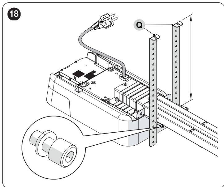
19. à l'aide d'une échelle, soulever l'opérateur jusqu'à ce que les étriers soient contre le plafond
