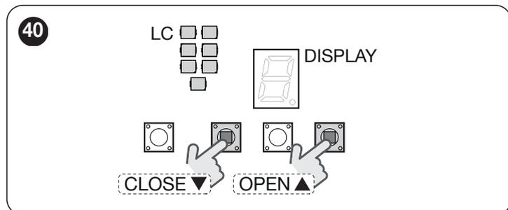
2. une manœuvre d'ouverture et une manœuvre de fermeture (ou vice versa) seront effectuées automatiquement et successivement pour permettre à la centrale d'évaluer la force nécessaire à utiliser dans les manœuvres suivantes
