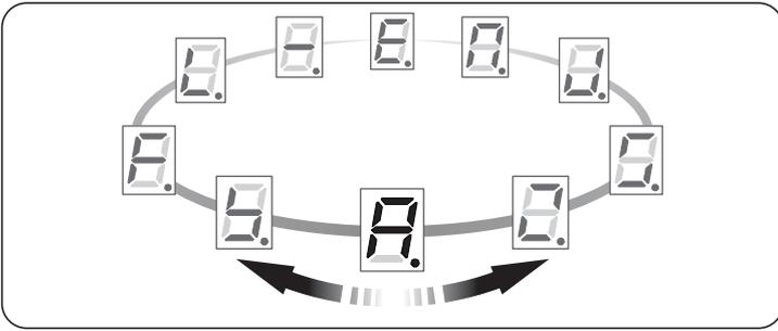
Cette fonction permet d'activer ou de désactiver la fermeture automatique à la fin d'une manœuvre d'ouverture et d'en modifier le temps d'attente. Si la fonction est active (valeurs de 1 à 9), la manœuvre de fermeture automatique commence à la fin du temps d'attente programmé (Temps de pause). Si la fonction n'est pas active (valeur 0), le fonctionnement de la centrale est de type « semi-automatique ».
