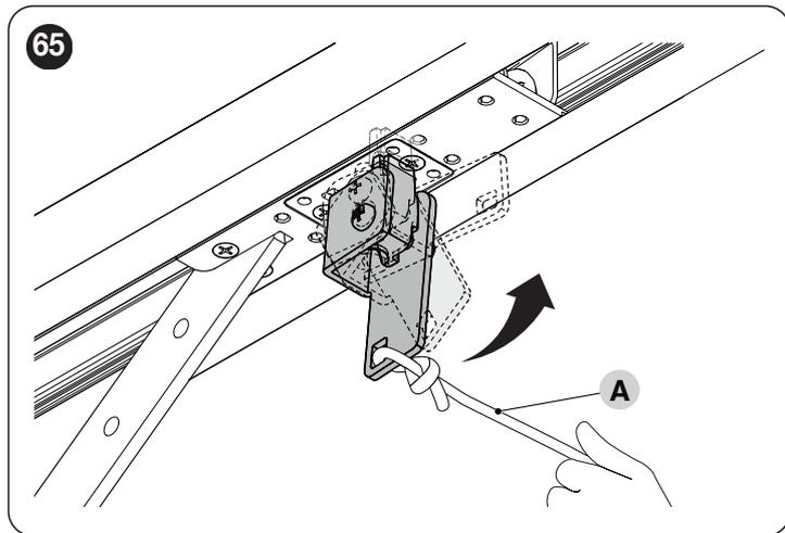
2. déplacer manuellement le portail afin d'aligner la partie inférieure du chariot moteur avec la partie supérieure et permettre de le placer dans son logement.
