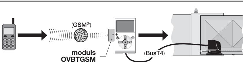
**Anwendung des Moduls OVBTGSM und der Software**
