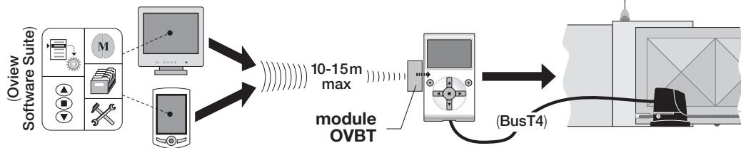
Gebruik van de OVBTGSM module en een mobiele telefoon
