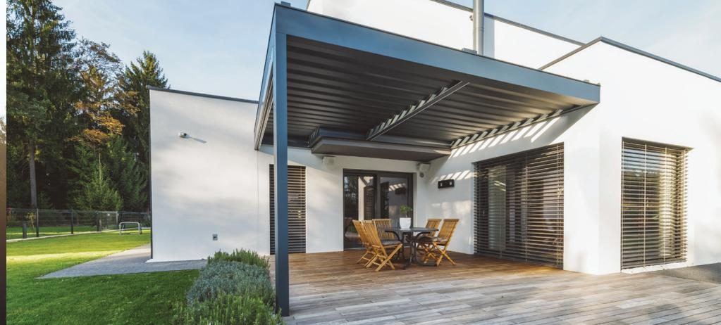
En cas de **vent fort**, les lames sont ouvertes pour éviter qu'elles ne soient endommagées en raison de leur résistance au vent.
