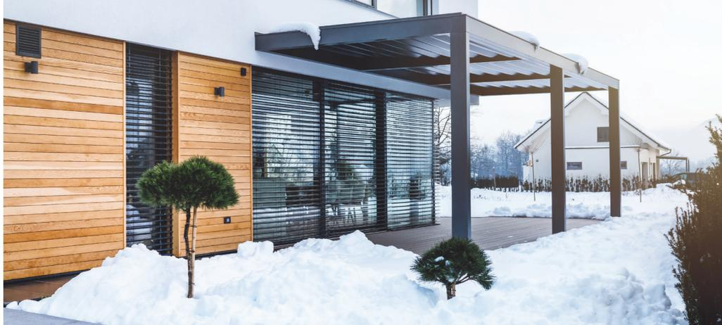
**Un capteur de température est inclus** dans le système NicePatio et prévient les éventuels dégâts provoqués par le gel. Quand le capteur de température détecte une température inférieure à 2 °C, les lames de la pergola s'entrouvent de 3 degrés afin d'empêcher la congélation lorsqu'elle sont en position fermée.
