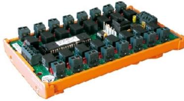
Le RA10-2 est un décodeur d'appel fonctionnant avec les platines NPH100 et NPH110.
