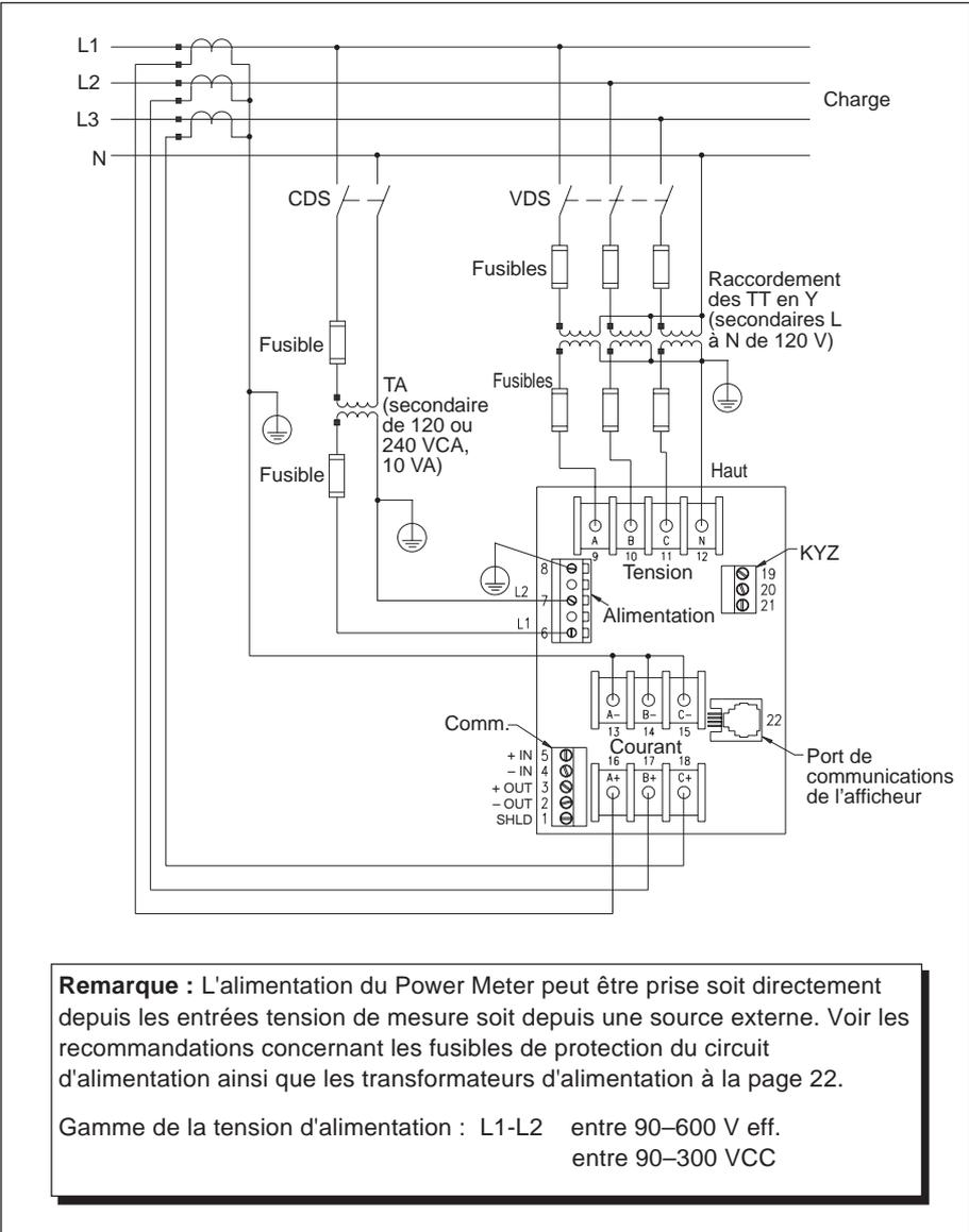
**Remarque :** L'alimentation du Power Meter peut être prise soit directement depuis les entrées tension de mesure soit depuis une source externe. Voir les recommandations concernant les fusibles de protection du circuit d'alimentation ainsi que les transformateurs d'alimentation à la page 22.
