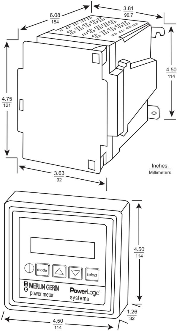
Figure B-1 : Dimensions du Power Meter et de l'afficheur
