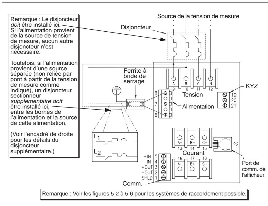
**Figure 5-1 : Ferrite à bride de serrage et disjoncteur pour la compatibilité électromagnétique (système à 4 fils représenté)**
