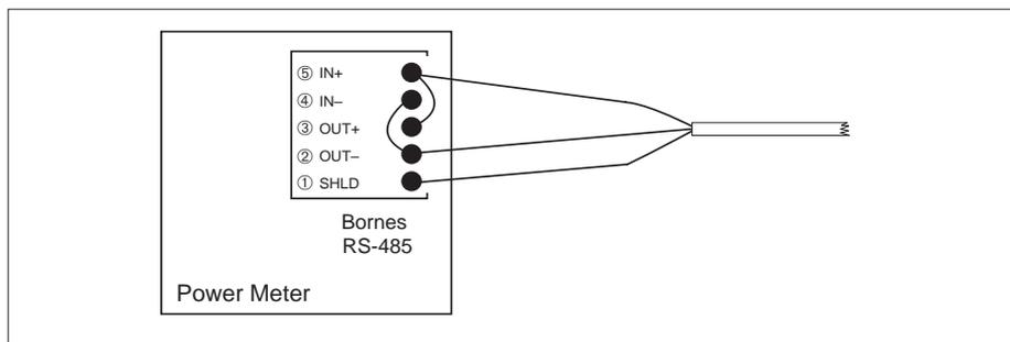
**Figure H-1 : Liaison Modbus ou Jbus en 2 fils**
