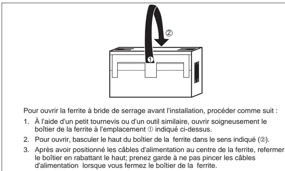
**Figure 5-2 : Ouverture de la ferrite à bride de serrage**
