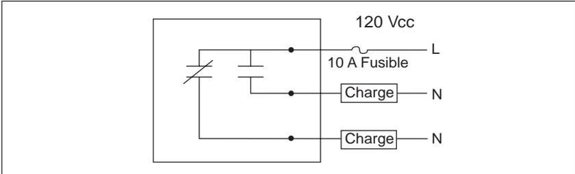
**Figure 5-11 : Connexion de sortie KYZ typique pour utiliser comme contact d'alarme**
