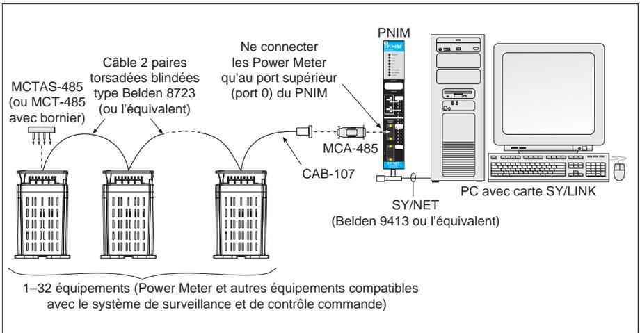
**Figure 6-2 : Power Meter connectés à un PNIM**
