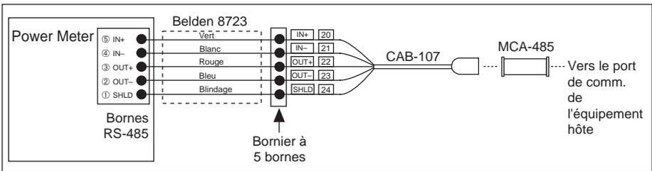
**Figure 6-6 : Raccordement du Power Meter comme premier équipement d'une liaison de communication**
