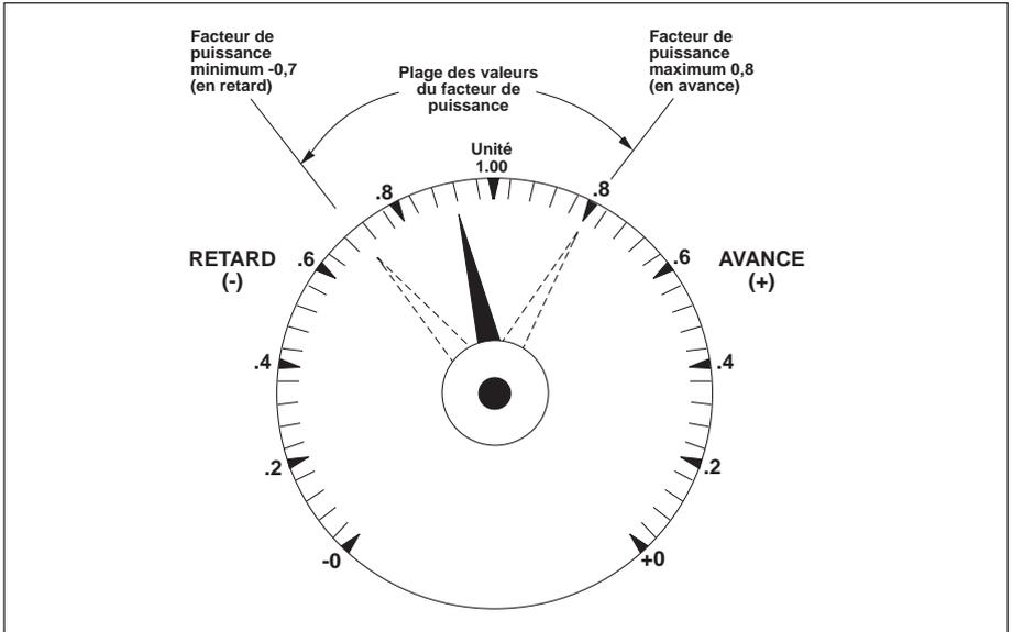
Figure 8-1 : Exemple de facteur de puissance min/max
