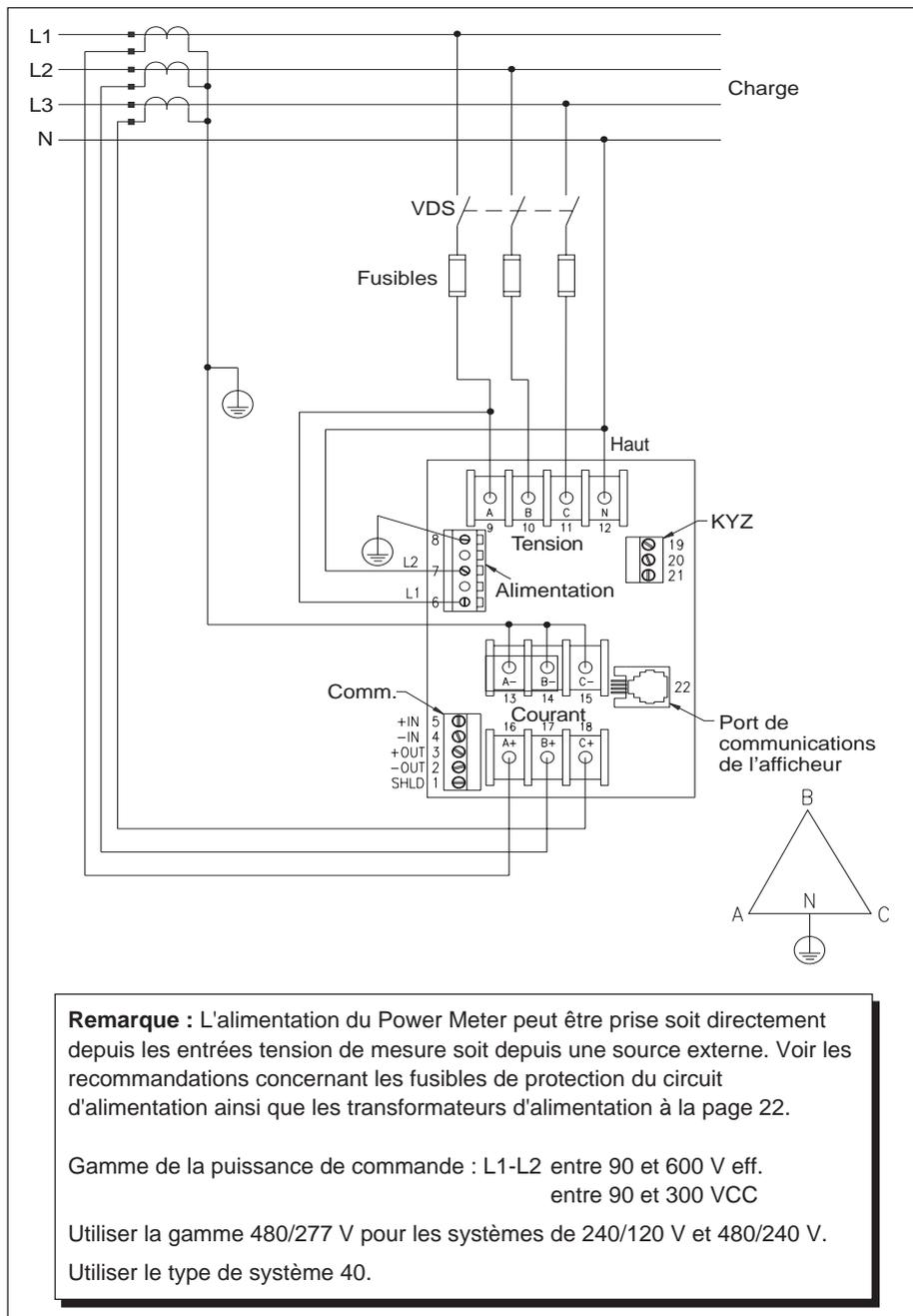
**Figure D-2 : Raccordement triphasé en triangle, à 4 fils avec 3 TT et 3 TC**
