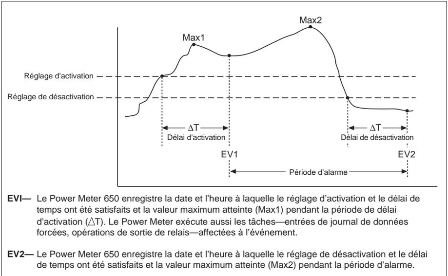
**Figure 9-1 : Traitement par le Power Meter des alarmes entraînées par les réglages**
