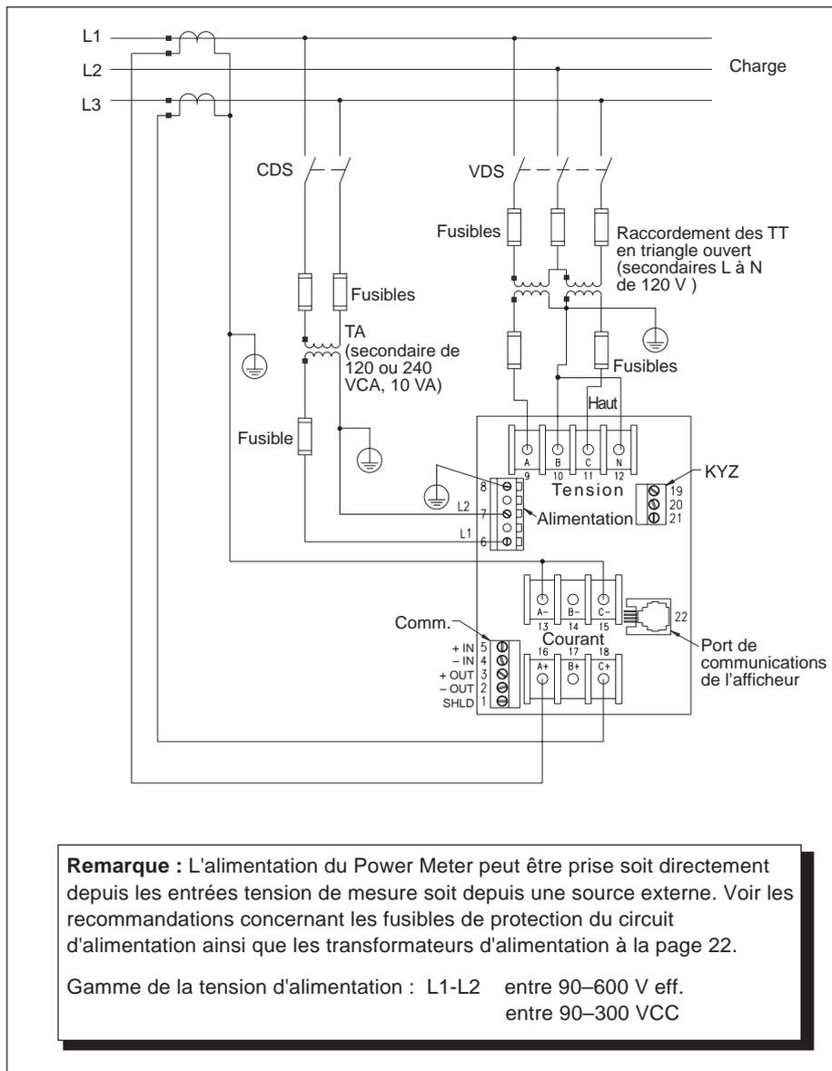
Figure 5-4 : Raccordement triphasé en triangle à 3 fils avec 2 TT et 2 TC
