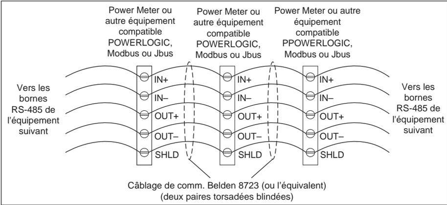
**Figure 6-5 : Raccordement en dérivation des bornes de communication RS-485**
