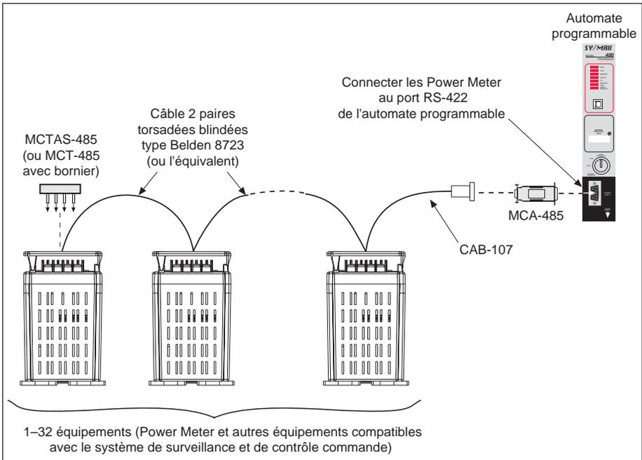
**Figure 6-3 : Power Meter connectés à un automate programmable SY/MAX**
