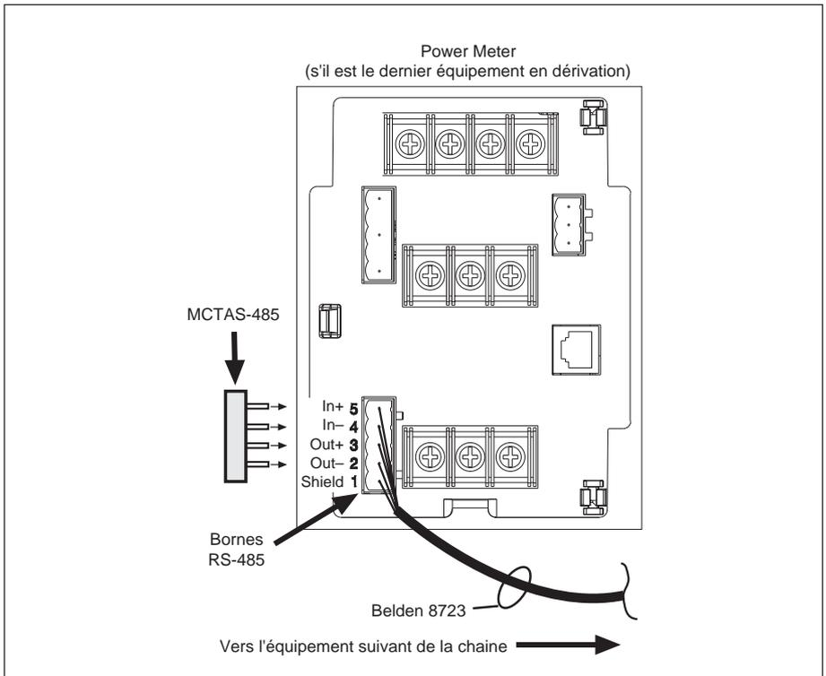
**Figure 6-7 : Power Meter équipé d'un adaptateur de fin de ligne MCTAS-485**
