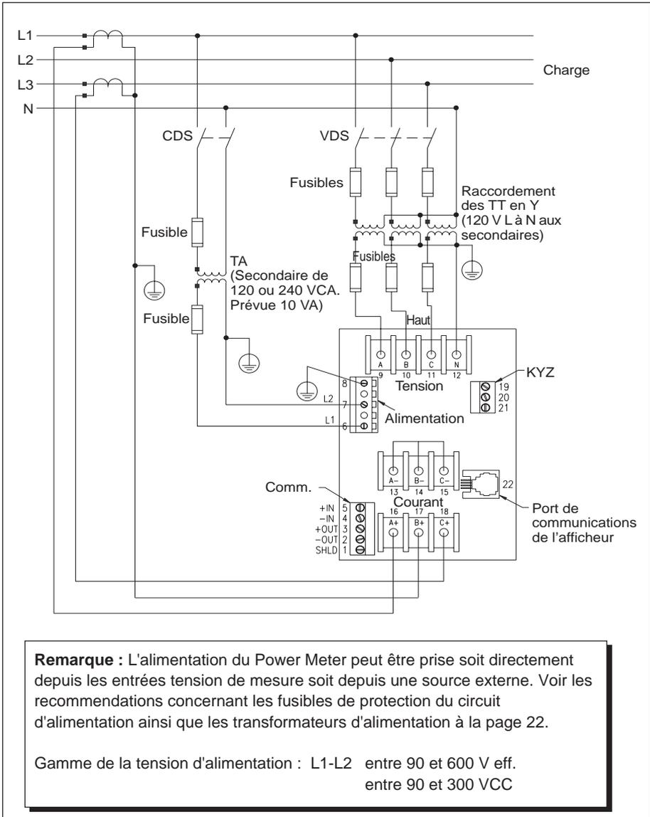
Figure D-3 : Raccordement triphasé en étoile, à 4 fils, charge à 3 fils avec 3 TT et 2 TC
