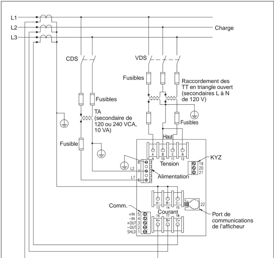
**Remarque :** L'alimentation du Power Meter peut être prise soit directement depuis les entrées tension de mesure soit depuis une source externe. Voir les recommandations concernant les fusibles de protection du circuit d'alimentation ainsi que les transformateurs d'alimentation à la page 22.
