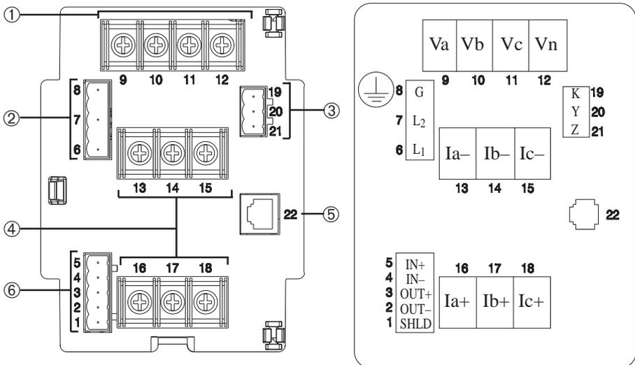
**Figure 3-3 :** Face avant du Power Meter et étiquette du couvercle des borniers
