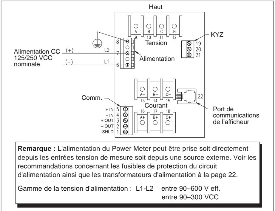
**Figure 5-8 : Câblage de la tension d'alimentation en CC**
