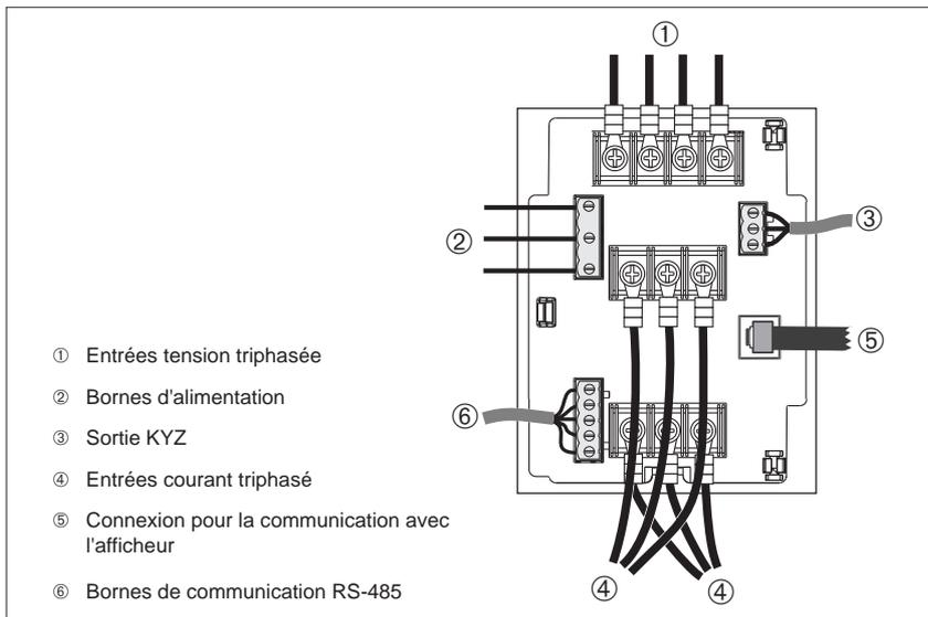
**Figure 5-9 : Acheminement des câbles du Power Meter**
