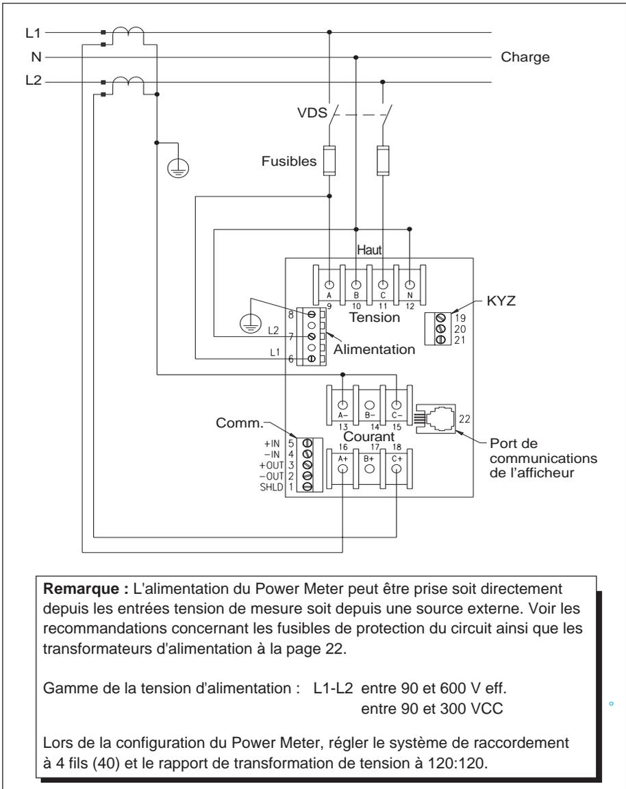
**Figure D-1 : Raccordement monophasée directe 240/120 V, à 3 fils avec 2 TC**
