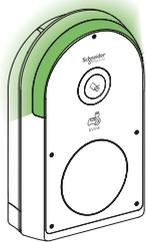
**fr** En cas d'erreur, le bandeau lumineux de la borne clignote en rouge toutes les dix secondes. L'utilisateur doit débrancher le câble. L'utilisateur obtiendra un premier diagnostic en comparant le nombre de clignotements avec le tableau ci-dessous. Vous pouvez réaliser un diagnostic plus complet avec eSetup.
