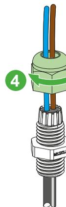
**fr** Si le diamètre du câble est supérieur à 6 mm, utiliser le passe-câble (A) à double entrée dans le presse-étoupe M12
