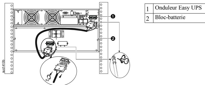
1. Localisez le couvercle du connecteur de la batterie sur le panneau arrière de l'onduleur et du bloc-batterie.
