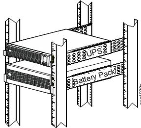
**REMARQUE :** Installez le bloc-batterie dans la baie. Consultez le manuel d'utilisation fourni avec le bloc-batterie pour les détails.
