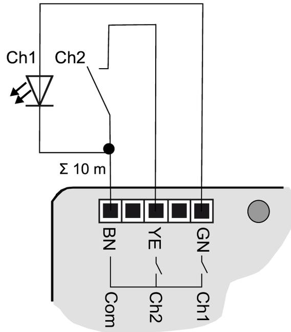
Image 7: Exemple de raccordement de l'interface de bouton-poussoir double
