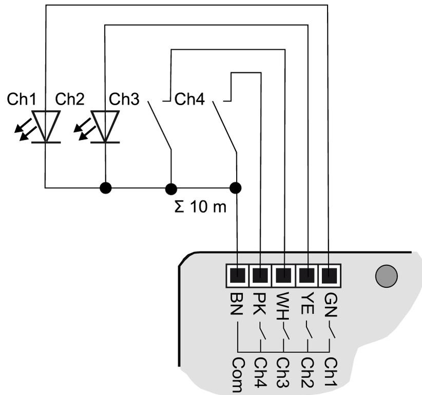
Image 8: Exemple de raccordement de l'interface de bouton-poussoir quadruple
