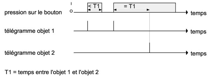
Image 16: Exemple de concept de commande « Objet 1 et objet 2 »
