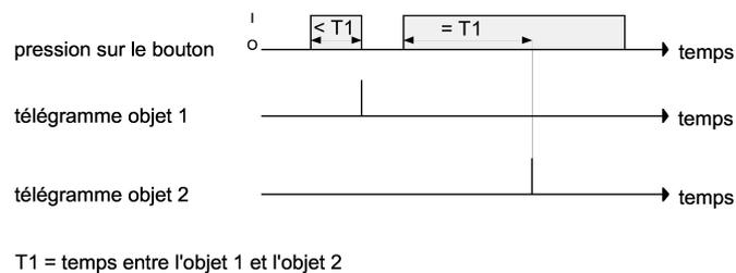
Image 15: Exemple de concept de commande « Objet 1 ou objet 2 »
