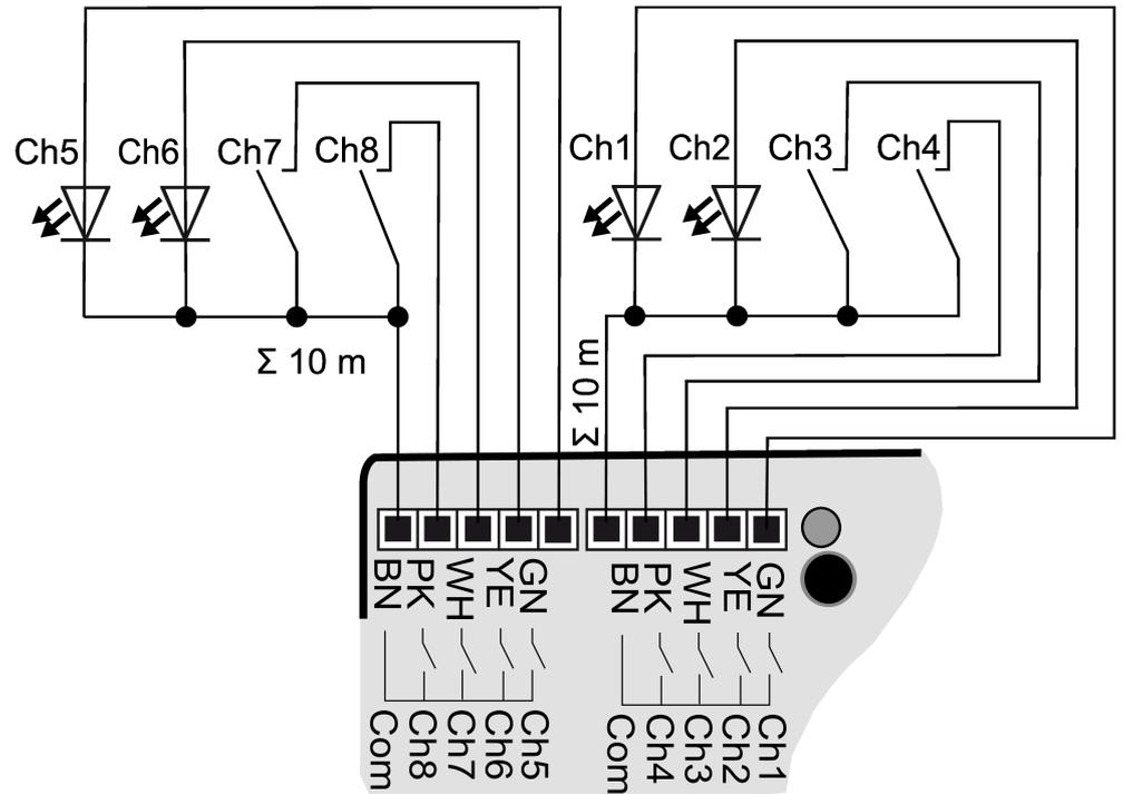
Image 9: Exemple de raccordement de l'interface de bouton-poussoir octuple
