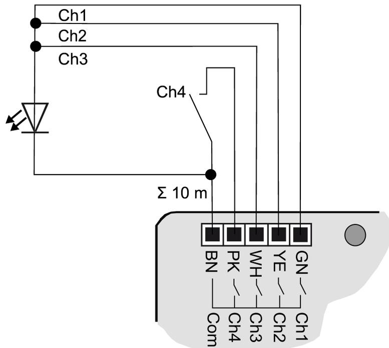
Image 10: Exemple de raccordement avec des sorties en parallèle
