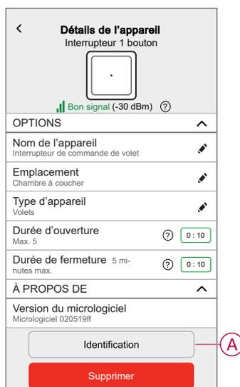
La LED d'état clignote en rouge et le volet s'ouvre/se ferme progressivement, une fois l'interrupteur de commande de volet ou les lames de volet identifiés.
