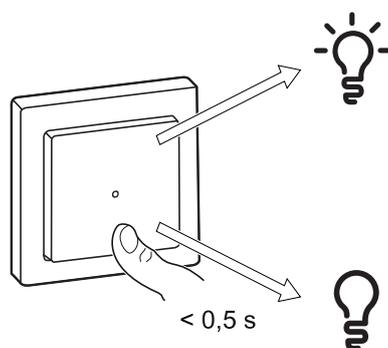
Appuyez longuement sur le bouton-poussoir (> 0,5 s) de l'appareil pour augmenter/réduire la luminosité du variateur.
