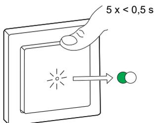
La lumière connectée à l'interrupteur variateur clignote quelques fois. La LED d'état cesse de clignoter en vert sur le commutateur sans fil et l'interrupteur variateur. L'interrupteur variateur peut désormais être contrôlé par le commutateur sans fil.
