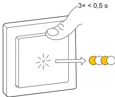
Attendez quelques secondes que la LED s'allume en vert et que l'application confirme que l'appareil est appairé.
