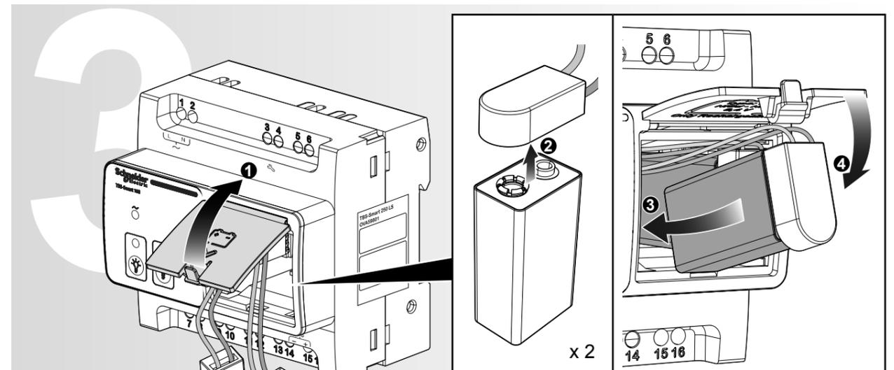
**Les TBS Smart sont livrés avec des accumulateurs qui seront raccordés lors du câblage de l'installation. Pile interdite**
