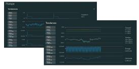
Visualisation des tendances pour chaque équipement surveillé (tension / intensité / facteur de puissance / énergie / demande / puissance apparente / puissance réactive, etc.)
