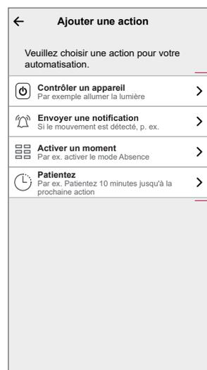
a. Dans cet exemple, nous allons d'abord sélectionner **Contrôler un appareil** et sélectionner **Variateur** (F) comme appareil déclenchant une action, puis nous sélectionnerons l'option **Patienter** pour ajouter un délai dans l'automatisme.
