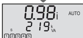
Apparent power 3 phases / Potenza apparente trifase
