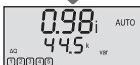
Control deviation in kvar / Deviazione di controllo in kvar
