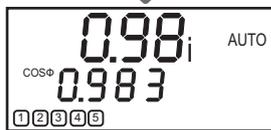
3 Decimal Displacement Power Factor (cos phi) / Fattore di potenza dello spostamento a 3 decimali (cos phi)
