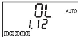
Capacitor overload current ratio (based on THDU calculation) / Rapporto di corrente di sovraccarico del condensatore (basato sul calcolo THDU)
