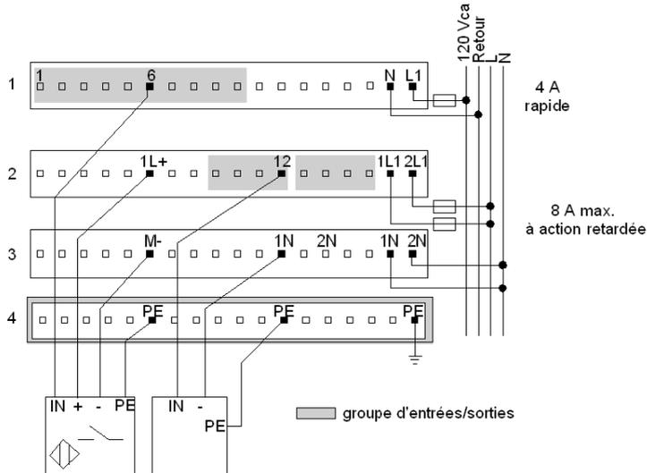
Une barre de commutation à une rangée est utilisée pour fournir une terre de protection (PE) au capteur à 4 fils. Aucune barre de commutation n'est requise si des capteurs à 2 et/ou 3 fils uniquement sont utilisés.
