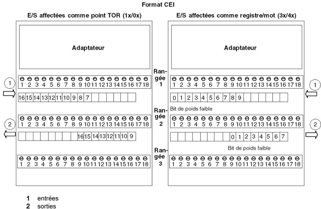
La figure ci-dessous indique la façon de mapper les données sur l'embase au moyen d'un adaptateur compatible schéma à contacts. Lorsque les E/S sont mappées comme des points TOR (1x/0x), le MSB est affecté à la broche 16 et le LSB est affecté à la broche 1. Lorsque les E/S sont mappées comme un mot ou un registre (3x/4x), le MSB (bit 15) est affecté à la broche 1 et le LSB (bit 0) est affecté à la broche 16.
