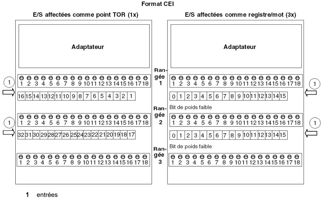
La figure ci-dessous indique la façon d'affecter les données sur l'embase avec un adaptateur compatible schéma à contacts 984. Lorsque les E/S sont affectées comme des points TOR (1x), le MSB est affecté à la broche 16 et le LSB est affecté à la broche 1. Lorsque les E/S sont affectées comme un mot ou un registre (3x), le MSB (bit 15) est affecté à la broche 1 et le LSB (bit 0) est affecté à la broche 16.
