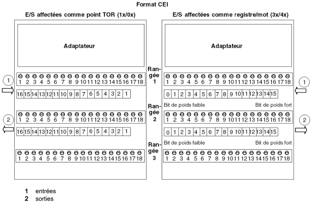
La figure ci-dessous indique la façon d'affecter les données sur l'embase avec un adaptateur compatible schéma à contacts. Lorsque les E/S sont affectées comme des points TOR (1x/0x), le MSB est affecté à la broche 16 et le LSB est affecté à la broche 1. Lorsque les E/S sont affectées comme un mot ou un registre (3x/4x), le MSB (bit 15) est affecté à la broche 1 et le LSB (bit 0) est affecté à la broche 16.
