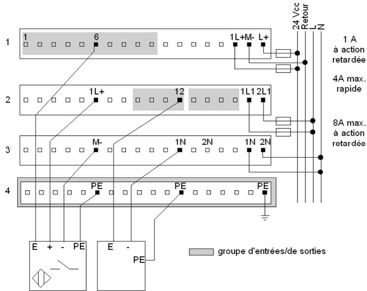
Une barre de commutation à une rangée est utilisée pour fournir une terre de protection (PE) au capteur à 4 fils. Aucune barre de commutation n'est requise si des capteurs à 2 et/ou 3 fils uniquement sont utilisés.
