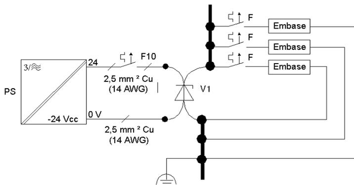
**F** Disjoncteur automatique ou fusible (voir schéma de câblage en unité dans la description de l'embase)
