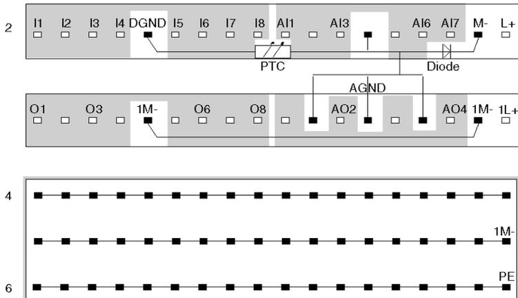
**NOTE :** AGND et DGND sont connectés en un seul point à l'intérieur du module. Les entrées numériques externes doivent être renvoyées à la borne DGND. Les circuits analogiques externes doivent être renvoyés aux bornes AGND.
