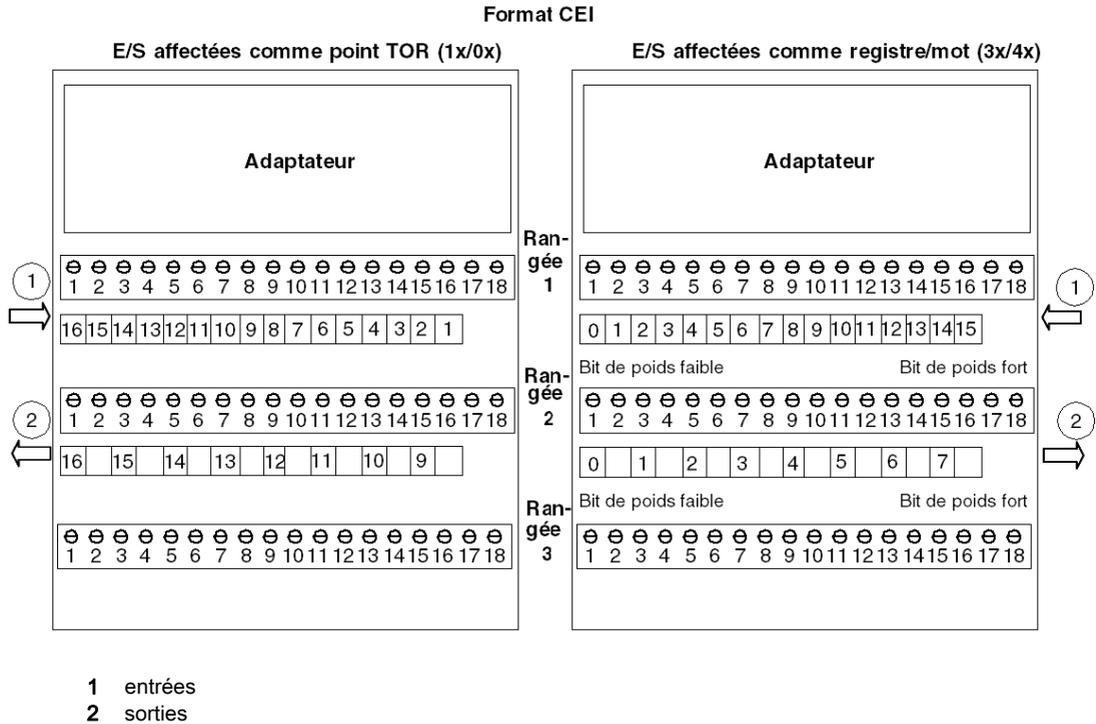
La figure ci-dessous indique la façon d'affecter les données sur l'embase avec un adaptateur compatible schéma à contacts. Lorsque les E/S sont affectées comme des points TOR (1x/0x), le MSB est affecté à la broche 16 et le LSB est affecté à la broche 1. Lorsque les E/S sont affectées comme un mot ou un registre, le MSB (bit 15) est affecté à la broche 1 et le LSB (bit 0) est affecté à la broche 16.
