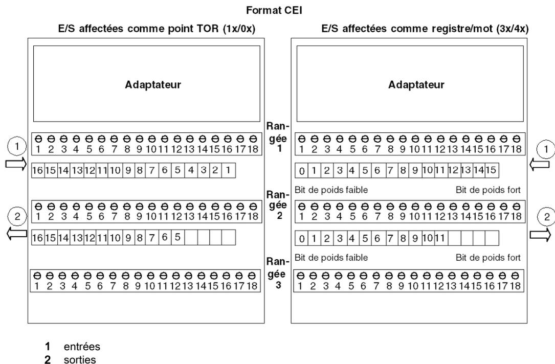
La figure ci-dessous indique la façon d'affecter les données sur l'embase avec un adaptateur compatible schéma à contacts. Lorsque les E/S sont affectées comme des points TOR (1x/0x), le MSB est affecté à la broche 16 et le LSB est affecté à la broche 1. Lorsque les E/S sont affectées comme un mot ou un registre (3x/4x), le MSB est affecté à la broche 1 et le LSB est affecté à la broche 16.
