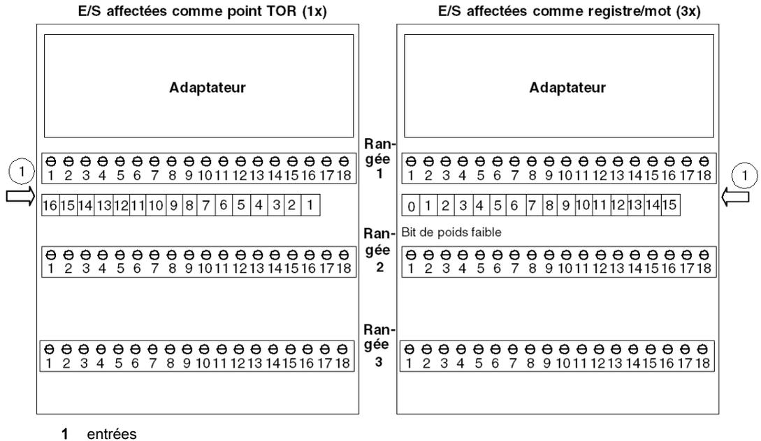
La figure ci-dessous indique la façon d'affecter les données sur l'embase avec un adaptateur conforme au schéma à contacts 984. Lorsque les E/S sont affectées en tant que points TOR (1x), le MSB est affecté à la broche 16 et le LSB est affecté à la broche 1. Lorsque les E/S sont affectées en tant que mot ou registre (3x), le MSB (bit 15) est affecté à la broche 1 et le LSB (bit 0) est affecté à la broche 16.
