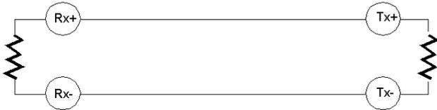
OU : Bornes à deux fils à 120 Ohm à chaque extrémité du réseau uniquement.
