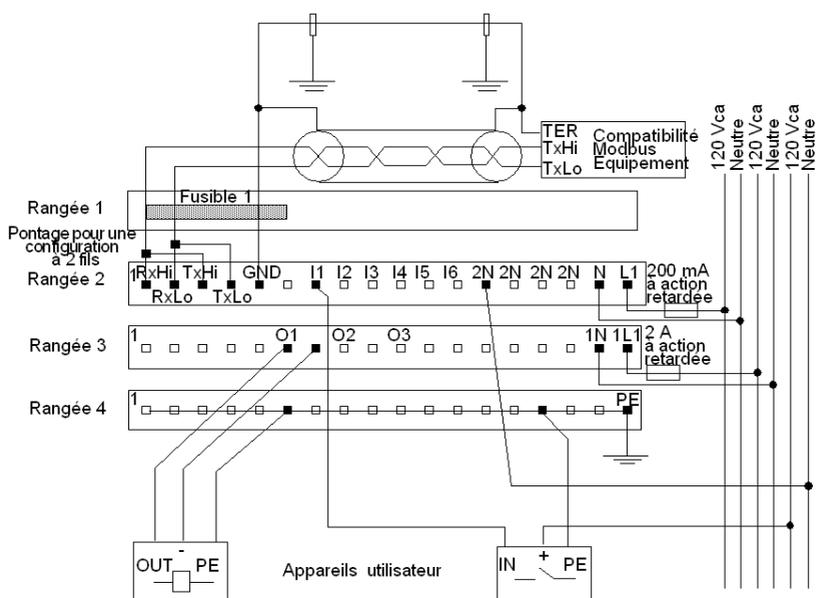
Le câble de communication doit être un câble à paire torsadée blindée. Attachez le blindage des deux extrémités à la terre à proximité de l'appareil Modbus associé.
