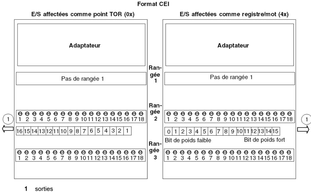
La figure ci-dessous indique la façon d'affecter les données sur l'embase avec un adaptateur compatible schéma à contacts 984. Lorsque les E/S sont affectées comme des points TOR (0x), le MSB est affecté à la broche 16 et le LSB est affecté à la broche 1. Lorsque les E/S sont affectées comme un mot ou un registre (4x), le MSB (bit 15) est affecté à la broche 1 et le LSB (bit 0) est affecté à la broche 16.
