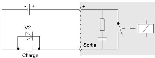
**V2** Diode de blocage utilisée comme circuit de protection
