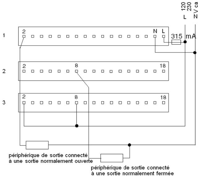
**NOTE :** Les 6 sorties à relais sont isolées les unes des autres. Ainsi, si une isolation est nécessaire, l'emploi de sources d'alimentation distinctes pour chaque sortie est possible.
