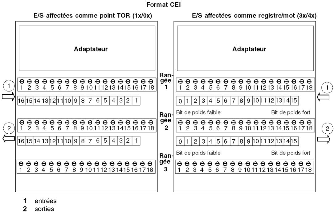
La figure ci-dessous indique la façon d'affecter les données sur l'embase avec un adaptateur compatible schéma à contacts 984. Lorsque les E/S sont affectées comme des points TOR (1x/0x), le MSB est affecté à la broche 16 et le LSB est affecté à la broche 1. Lorsque les E/S sont affectées comme un mot ou un registre (3x/4x), le MSB (bit 15) est affecté à la broche 1 et le LSB (bit 0) est affecté à la broche 16.
