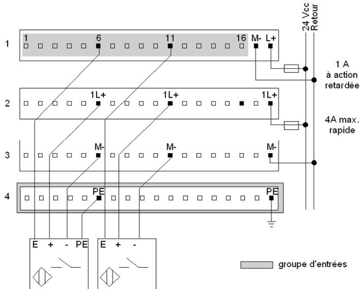
Une barre de commutation à une rangée est utilisée pour fournir une terre de protection (PE) au capteur à 4 fils. Aucune barre de commutation n'est requise si des capteurs à 2 et/ou 3 fils uniquement sont utilisés.
