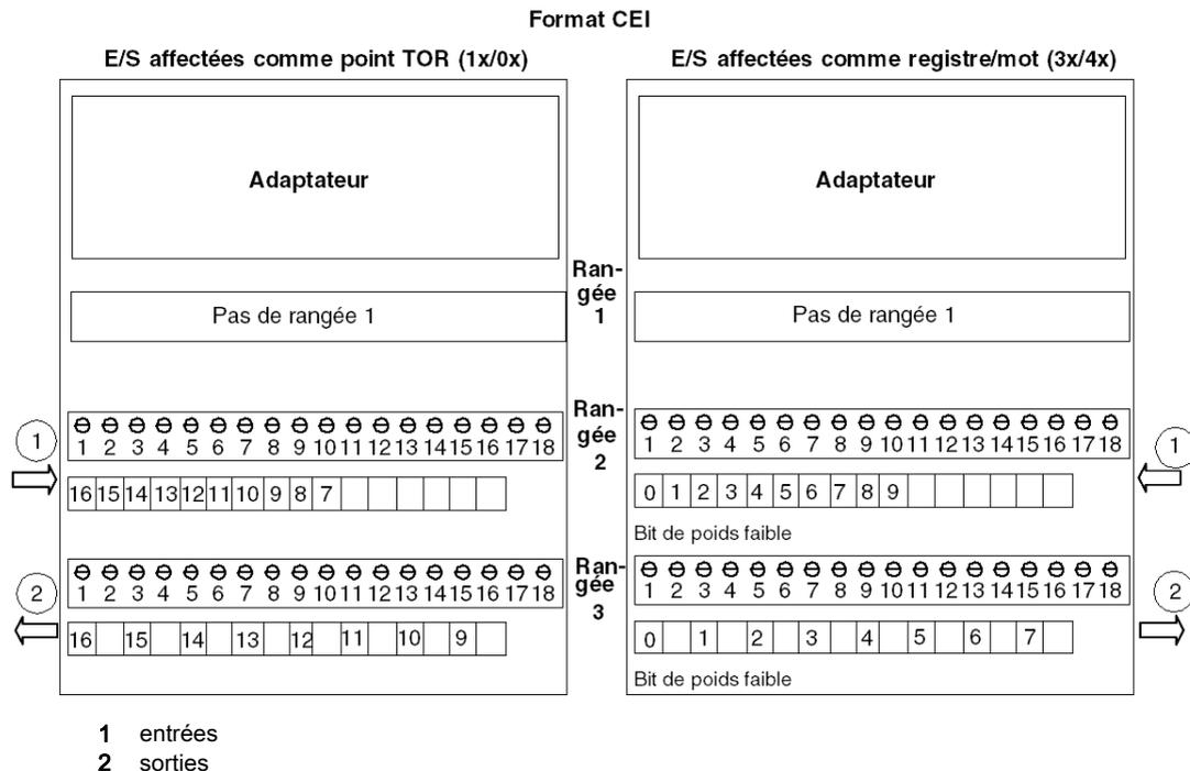
La figure ci-dessous indique la façon d'affecter les données sur l'embase avec un adaptateur compatible schéma à contacts. Lorsque les E/S sont affectées en tant que points TOR (1x/0x), le MSB est affecté à la broche 16 et le LSB est affecté à la broche 1. Lorsque les E/S sont affectées comme un mot ou un registre (3x/4x), le MSB (bit 15) est affecté à la broche 1 et le LSB (bit 0) est affecté à la broche 16.
