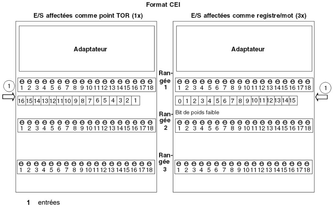
La figure ci-dessous indique la façon d'affecter les données sur l'embase avec un adaptateur compatible schéma à contacts 984. Lorsque les E/S sont affectées comme des points TOR (1x), le MSB est affecté à la broche 16 et le LSB est affecté à la broche 1. Lorsque les E/S sont affectées comme un mot ou un registre (3x), le MSB (bit 15) est affecté à la broche 1 et le LSB (bit 0) est affecté à la broche 16.
