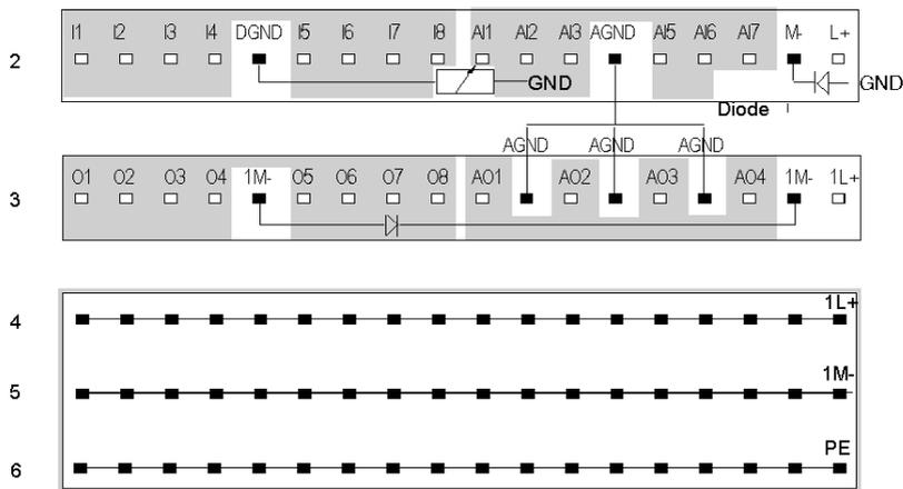
**NOTE :** AGND et DGND sont séparés de manière interne dans le module. Les entrées numériques externes doivent être renvoyées à la borne DGND. Les circuits analogiques externes doivent être renvoyés aux bornes AGND.
