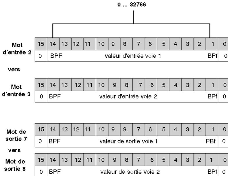
**NOTE :** La résolution du module est égale à 14 bits (0 à 32766 décimal ou 0 à 7FFE hex).
