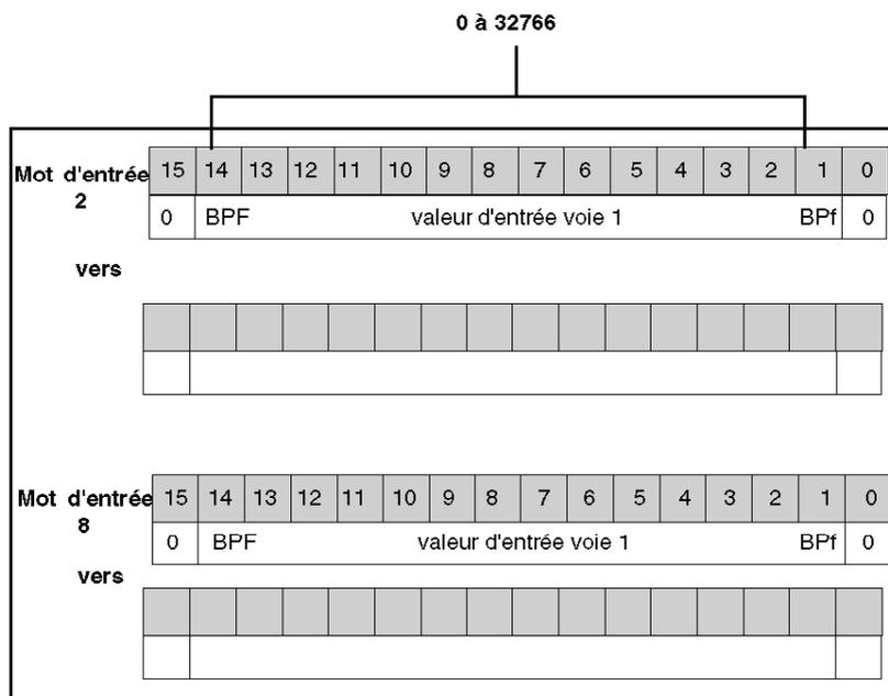
**NOTE** : La résolution du module est égale à 14 bits (0 à 32766 décimal ou 0 à 7FFE hexadécimal).
