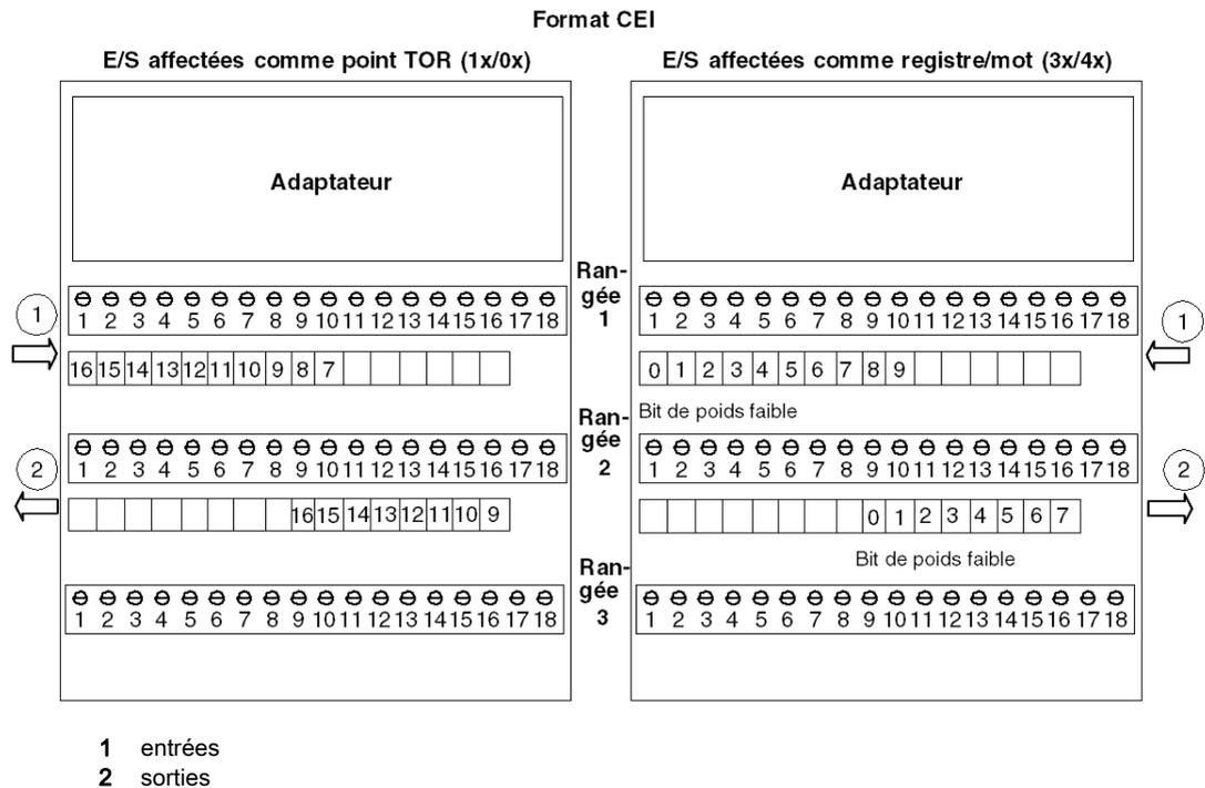
La figure ci-dessous indique la façon d'affecter les données sur l'embase avec un adaptateur compatible schéma à contacts. Lorsque les E/S sont affectées comme des points TOR (1x/0x), le MSB est affecté à la broche 16 et le LSB est affecté à la broche 1. Lorsque les E/S sont affectées comme un mot ou un registre (3x/4x), le MSB (bit 15) est affecté à la broche 1 et le LSB (bit 0) est affecté à la broche 16.
