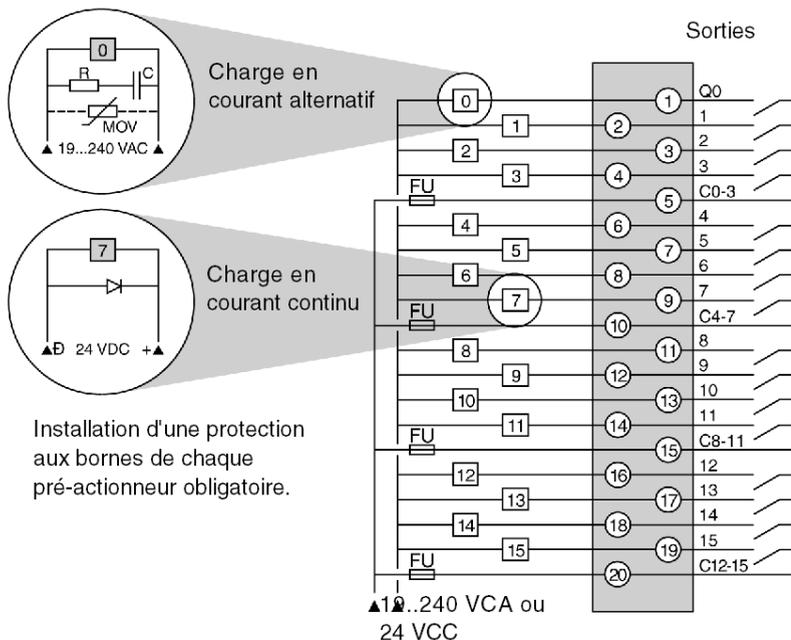
Installation d'une protection aux bornes de chaque pré-actionneur obligatoire.
