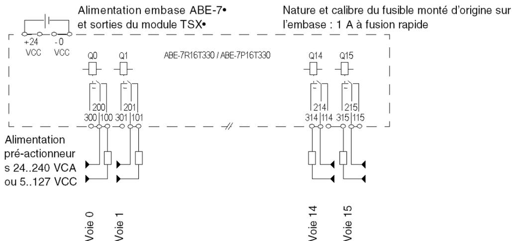
**NOTE :** Prévoir un fusible de protection par pré-actionneur ou par groupe si ceux-ci sont alimentés de la même tension.
