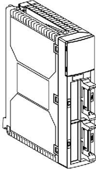
Le module **TSX DSY 32T2K** est un module de sorties statiques TOR à connecteur à 32 voies pour courant continu.
