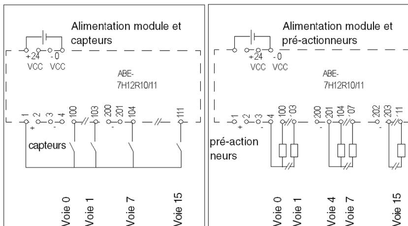
Raccordement du commun pour capteurs :
