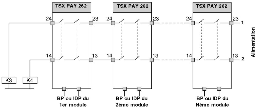
**NOTE :** faites attention à la chute de tension dans le système de sortie, due à la résistance de 0,1 Ohm du contact du relais de sécurité, qui varie selon le courant de relais.
