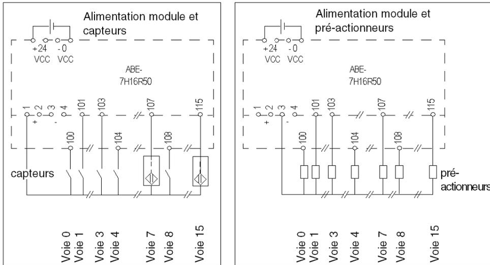
Raccordement du commun pour capteurs :
