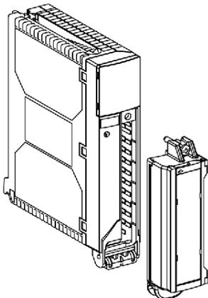
Le module est équipé d'un bornier de connexion à vis de 20 bornes débrochable, permettant de raccorder les sorties :
