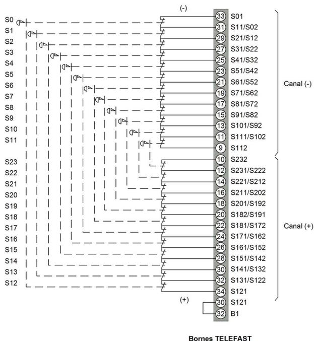
**NOTE :** Si moins de 12 doubles contacts sont utilisés, les bornes d'entrée inutilisées doivent être pontées.
