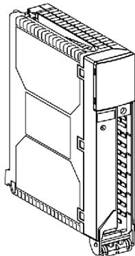
Le module **TSX DSY 16S5** est un module de sorties triac TOR à bornier à 16 voies.
