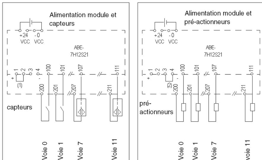
Raccordement du commun pour capteurs :
