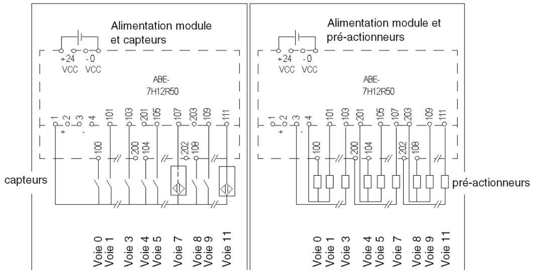
Raccordement du commun pour capteurs :
