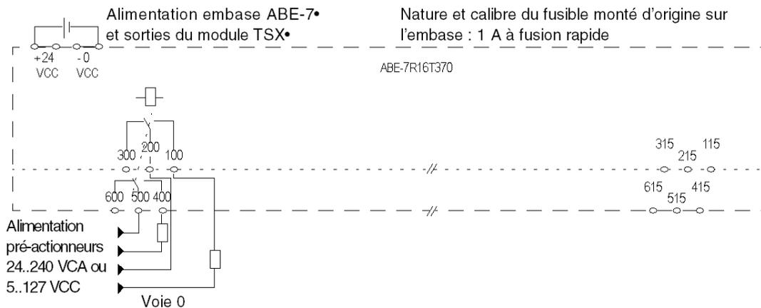
**NOTE :** Prévoir un fusible de protection par pré-actionneur ou par groupe si ceux-ci sont alimentés de la même tension.
