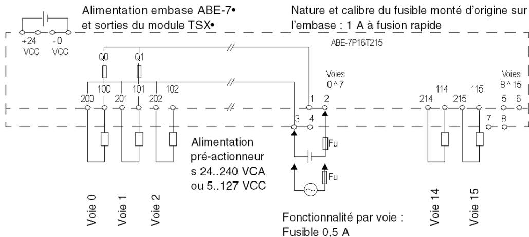
**Fu** Courant nominal des fusibles à la charge.**NOTE** : Protection des contacts de relais :
