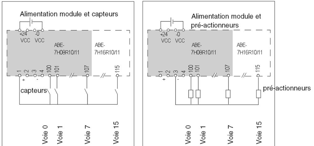
Raccordement du commun pour capteurs :
