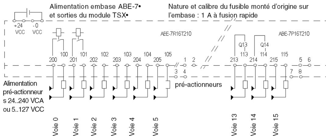
**NOTE :** Prévoir un fusible de protection par pré-actionneur ou par groupe si ceux-ci sont alimentés de la même tension.
