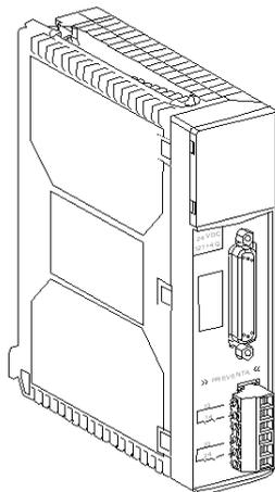
Le module **TSX PAY 262** est un module de sécurité d'entrées/sorties développé pour satisfaire aux exigences des normes européennes et internationales concernant les équipements électroniques d'automatisme industriel et les circuits de sécurité.
