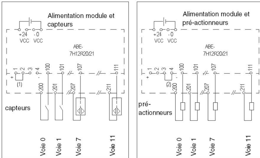
Raccordement du commun pour capteurs :
