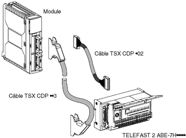
**NOTE :** Vérifiez la cohérence entre le calibre du fusible intégré au TELEFAST 2 et le fusible à utiliser sur les entrées/sorties (voir Raccordements aux modules).
