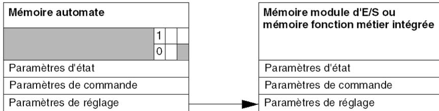
Lorsque l'instruction est scrutée par l'automate (PLC), le bit d'**échange en cours** est mis à 1 dans `%MWr.m.c.`
