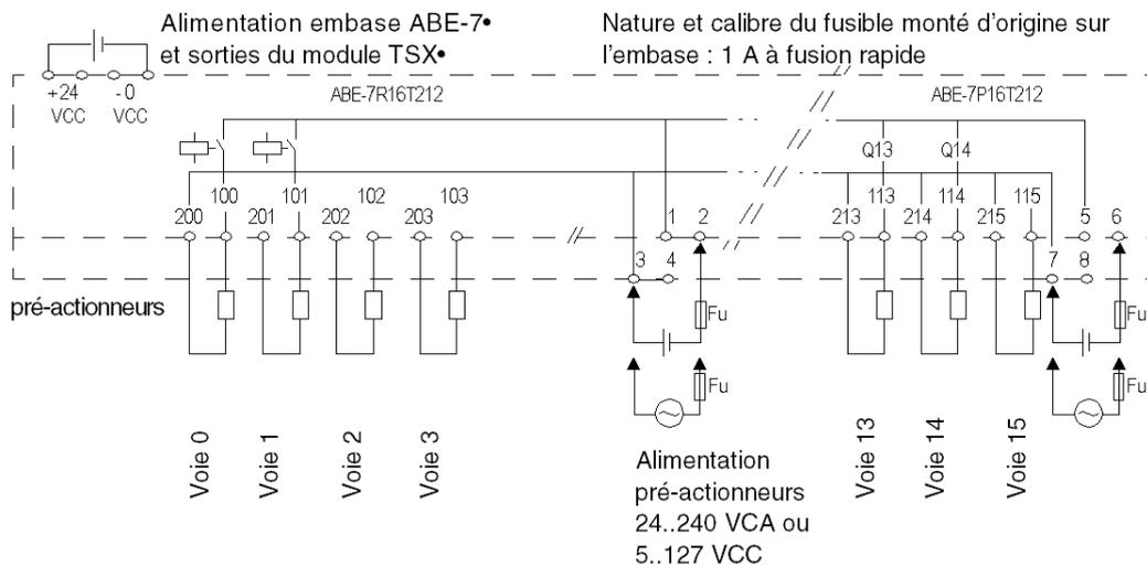
**Fu** Courant nominal des fusibles à la charge.**NOTE** : Protection des contacts de relais :
