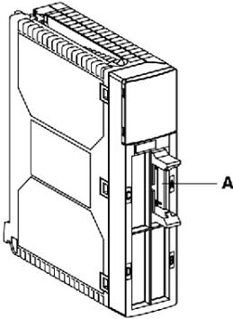
Ce module est équipé d'un connecteur **HE10** mâle (A) relié à la connexion des entrées 0 à 15.
