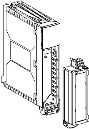
Ce module est équipé d'un bornier de connexion débrochant permettant le raccordement des entrées.
