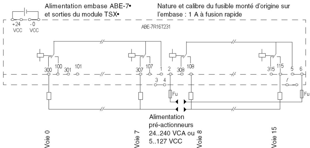
**Fu** Courant nominal des fusibles à la charge.**NOTE** : Protection des contacts de relais :
