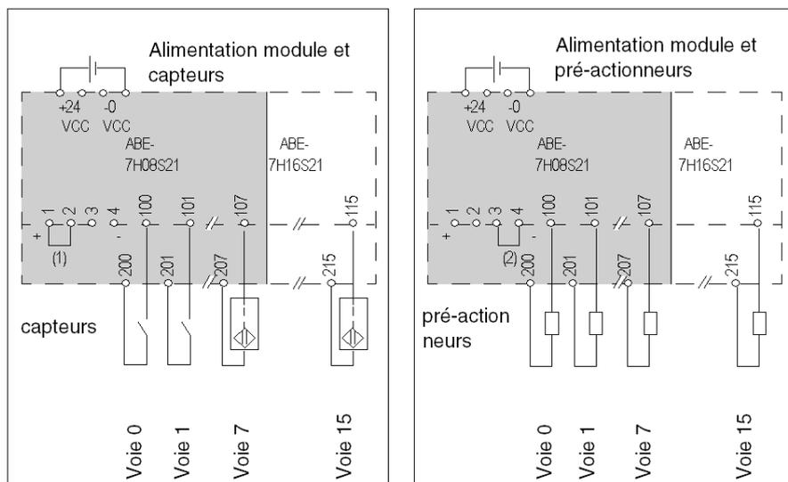
Raccordement du commun pour capteurs :
