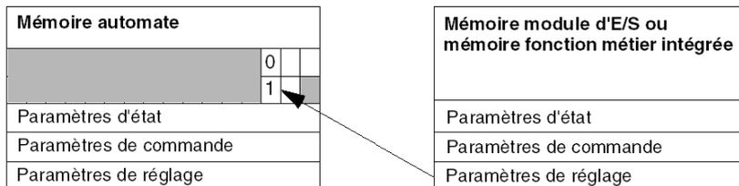
Lorsque les données sont échangées entre la mémoire de l'automate (PLC) et le module, le bit `ADJ_ERR (%MWr.m.c.1.2)` gère l'acquittement par le module.
