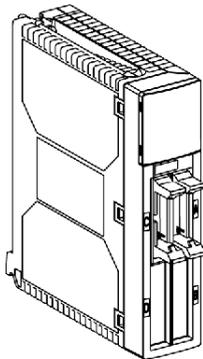
Le module **TSX DEY 32D3K** est un module d'entrées TOR à connecteur à 32 voies 48 VCC, logique positive.
