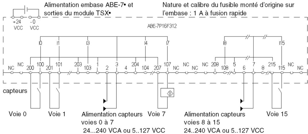
**NOTE :** Prévoir un fusible de connexion pour l'alimentation des capteurs.
