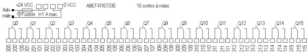
**ABE-7R16T330/P16T330** 16 sorties à relais, 1 OF, contact libre de potentiel, ABE-7R16T330 avec relais électromagnétiques, relais ABE-7P16T330 non fournis.
