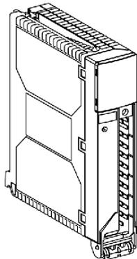
Le module **TSX DEY 16A2** est un module d'entrées TOR à bornier à 16 voies 24 VCA.
