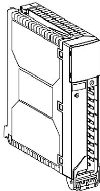
Le module **TSX DSY 08T22** est un module de sorties statiques TOR à bornier à 8 voies pour courant continu (logique positive).
