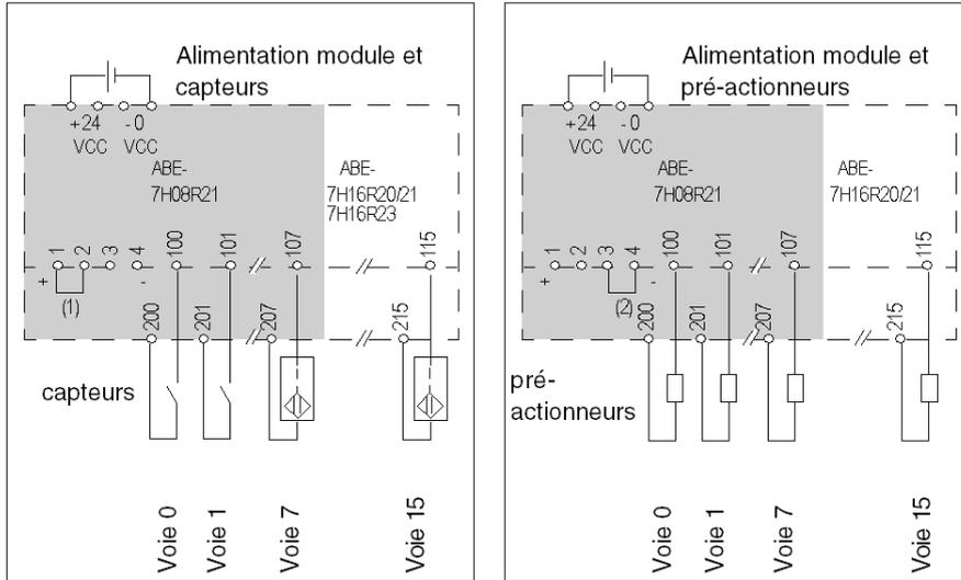
Raccordement du commun pour capteurs :
