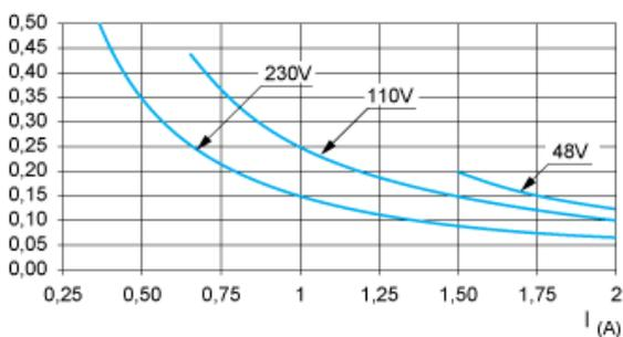
AC15 contrôle des charges électromagnétiques  $> 72 \text{ VA}$ , pour établir le contact :  $\cos \phi = 0,7$ , pour le couper :  $\cos \phi = 0,4$ .
