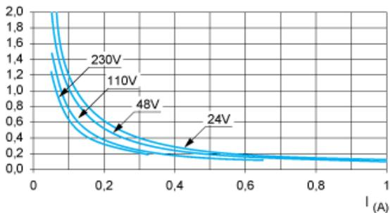
AC14 contrôle des petites charges électromagnétiques  $\leq 72 \text{ VA}$ , pour établir le contact :  $\cos \phi = 0,3$ , pour le couper :  $\cos \phi = 0,3$ .
