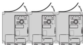
Variateurs accolés, le cache de l'orifice de ventilation doit être retiré. Le degré de protection devient IP20.
