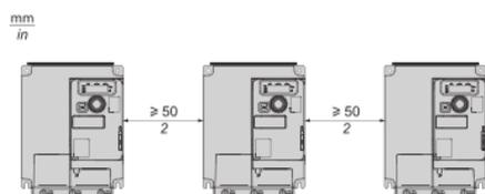
Espace libre  $\geq 50$  mm (2 po.) de chaque côté, avec le cache de l'orifice de ventilation en place.
