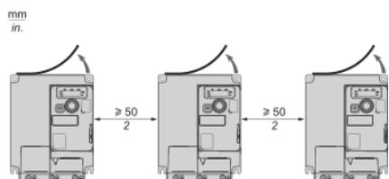
Espace libre  $\geq 50$  mm (2 po.) de chaque côté. Le cache de l'orifice de ventilation doit être retiré pour un fonctionnement avec une température de l'air ambiant supérieure à 50 °C (122 °F). Le degré de protection devient IP20.
