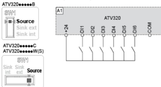
Commutateur SW1 réglé sur la position "Source" et utilisation d'une alimentation externe pour les entrées TOR.
