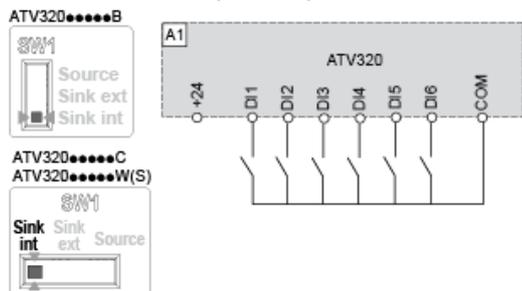
Commutateur SW1 réglé sur la position "Sink Ext" et utilisation d'une alimentation externe pour les entrées TOR.
