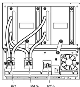
**NOTE :** Les bornes PA+ et PC- sont exclusivement utilisées pour mesure la tension du bus DC ; elles ne sont pas prévues pour être raccordées à des fins d'usage extérieur.
