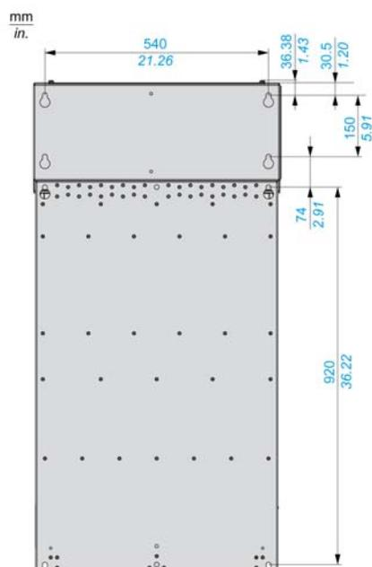
**NOTE :** La pièce inférieure de la boîte de jonction est vendue séparément. Cette pièce permet le montage mural de l'appareil. Elle fournit un degré de protection IP21 sur le bas et un degré de protection de type 1 UL.
