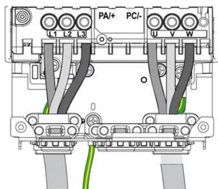
**NOTE :** Les bornes PA/+ et PC/- sont exclusivement utilisées pour mesure la tension du bus DC ; elles ne sont pas prévues pour être raccordées à des fins d'usage extérieur.
