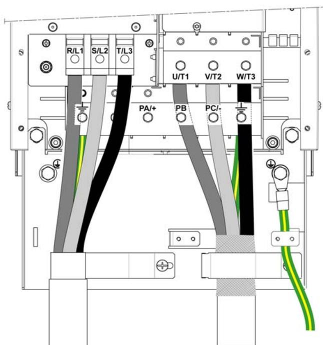
**NOTE :** Les bornes PA/+ et PC/- sont exclusivement utilisées pour mesure la tension du bus DC ; elles ne sont pas prévues pour être raccordées à des fins d'usage extérieur.
