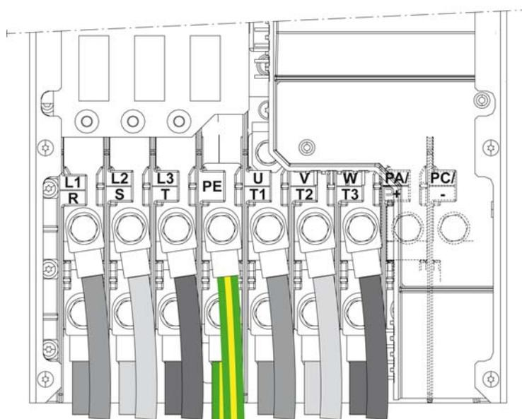
**NOTE :** Les bornes PA/+ et PC/- sont exclusivement utilisées pour mesurer la tension du bus DC ; elles ne sont pas prévues pour être raccordées à des fins d'usage extérieur.
