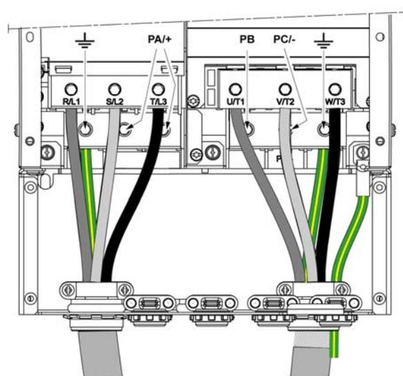
**NOTE :** Les bornes PA/+ et PC/- sont exclusivement utilisées pour mesurer la tension du bus DC ; elles ne sont pas prévues pour être raccordées à des fins d'usage extérieur.
