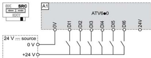
Réglez le commutateur sur la position **SK (Collecteur)**, en utilisant la sortie d'alimentation pour les entrées **TOR**.
