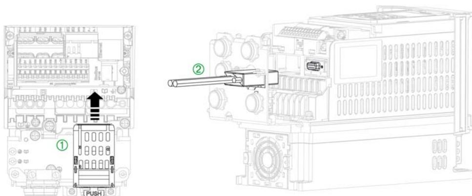
Pour aider à garantir le câblage correct de la partie contrôle, appliquez les instructions suivantes pour installer le module de bus de terrain PROFIBUS sur les variateurs de taille 1.
