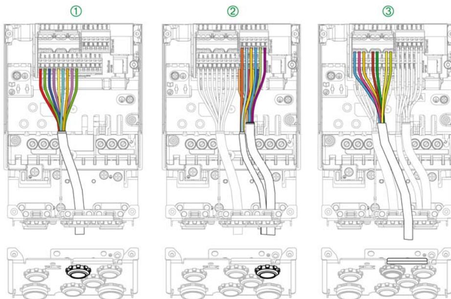
**NOTE :** La plaque de câblage illustrée correspond à la taille 2. Les autres plaques de câblage ont un aspect légèrement différent de celle-ci.
