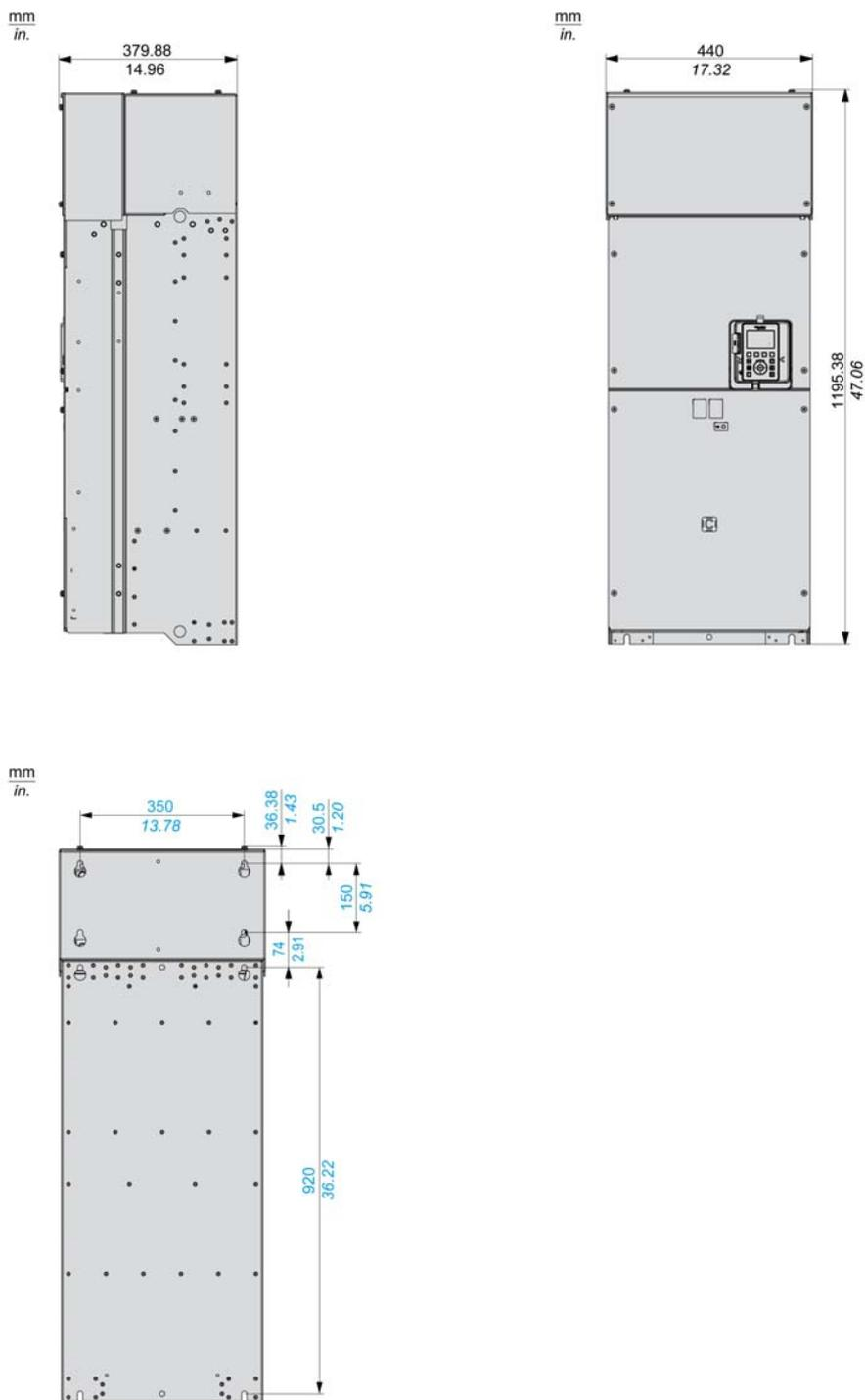
**NOTE :** La pièce inférieure de la boîte de jonction est vendue séparément. Cette pièce permet le montage mural de l'appareil. Elle fournit un degré de protection IP21 sur le bas et un degré de protection de type 1 UL.
