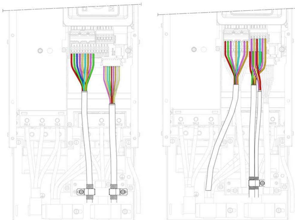
Exemple : chemin de câble pour taille 5Y avec tension réseau 500-690 V
