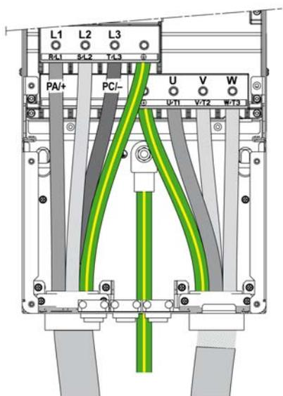
**NOTE :** Les bornes PA/+ et PC/- sont exclusivement utilisées pour mesure la tension du bus DC ; elles ne sont pas prévues pour être raccordées à des fins d'usage extérieur.
