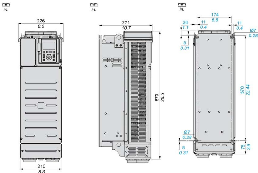
Variateurs IP20 sauf en face inférieure (IP00) - Vue avant, latérale et arrière
