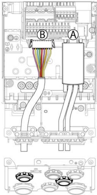
**NOTE :** La plaque de câblage illustrée correspond à la taille 2. Les autres plaques de câblage ont un aspect légèrement différent de celle-ci.
