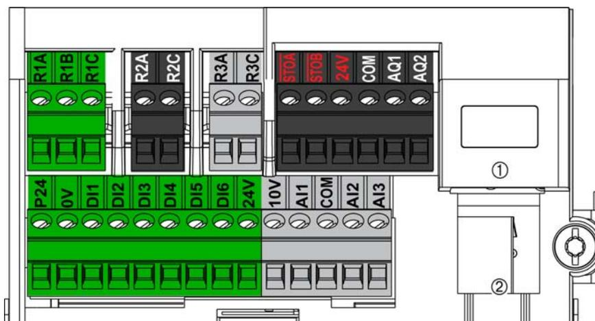
① Ethernet Modbus TCP, ② Modbus en série
