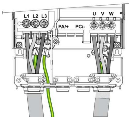
**NOTE :** Les bornes PA/+ et PC/- sont exclusivement utilisées pour mesurer la tension du bus DC ; elles ne sont pas prévues pour être raccordées à des fins d'usage extérieur.
