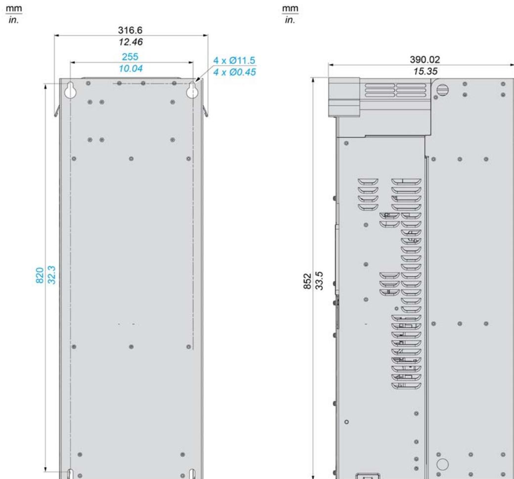
Variateurs IP20 - Vue arrière, avant et latérale avec le capot supérieur et la boîte de jonction
