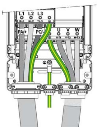
**NOTE :** Les bornes PA/+ et PC/- sont exclusivement utilisées pour mesure la tension du bus DC ; elles ne sont pas prévues pour être raccordées à des fins d'usage extérieur.
