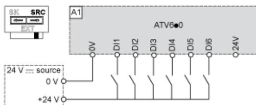
Réglez le commutateur sur la position SK (Collecteur), en utilisant la sortie d'alimentation pour les entrées numériques
