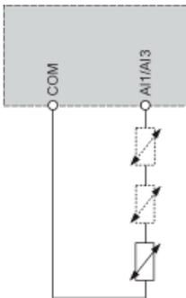
Il est possible de raccorder 1 ou 3 capteurs sur les bornes AI1 ou AI3
