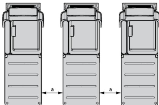
Tailles de châssis 1, 2, 3, 3S et 5S :  $a \geq 100$  mm (3,9 po.)
