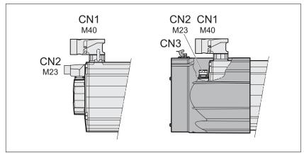
Figure 16: Connection overview BMH1904 ••• • A and BMH1904 ••• • B
