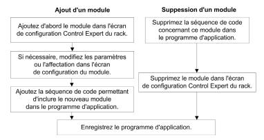
**NOTE**: une transaction CCOTF permet d'ajouter ou de supprimer jusqu'à quatre modules sur une station d'E/S distantes Ethernet.
