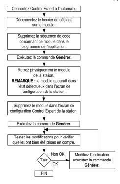
**NOTE**: Une station Ethernet RIO permet de supprimer jusqu'à quatre modules au cours d'une même transaction CCOTF.
