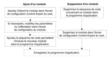
**NOTE**: une transaction CCOTF permet d'ajouter ou de supprimer jusqu'à quatre modules sur une station RIO Ethernet.
