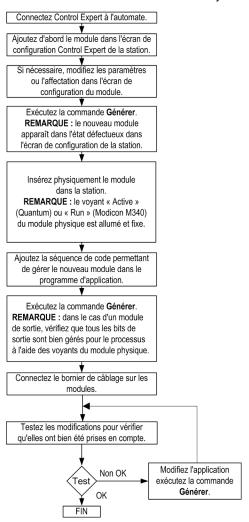
**NOTE**: Une transaction CCOTF permet d'ajouter jusqu'à quatre modules à une station d'E/S distantes Ethernet.
