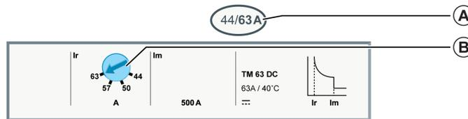
**A** Plage de réglage du déclencheur magnéto-thermique TM-D 3P/4P
