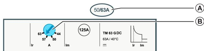
**A** Plage de réglage du déclencheur magnéto-thermique TM-G
