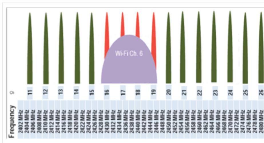
La plage de fréquences associée à la voie sélectionnée dans la passerelle est également utilisable par un autre système sans fil, comme un réseau Wi-Fi, et par les équipements sans fil tiers de ce système.
