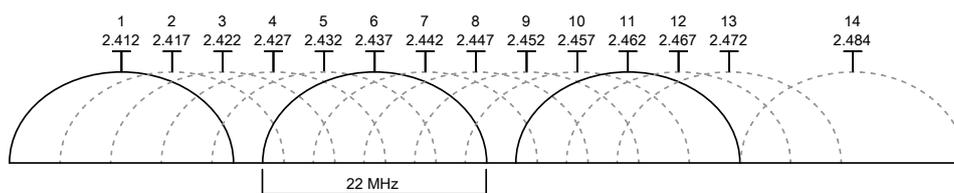
Par exemple, la voie Wi-Fi 6 (bande passante de 2 427 à 2447 MHz) et les voies sans fil 16, 17, 18 et 19 du système PowerTag (bandes passantes de 2 429 à 2431 MHz, de 2 434 à 2 436 MHz, de 2 439 à 2 441 MHz et de 2 444 à 2 446 MHz respectivement) sont basés sur la même plage de fréquences. Il est donc recommandé d'éviter ces voies.
