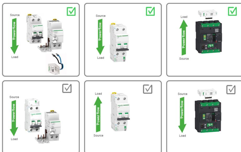
**Règle GEN3 : montez le capteur d'énergie PowerTag en amont d'un contacteur, d'un variateur de vitesse ou d'un démarreur de moteur.**
