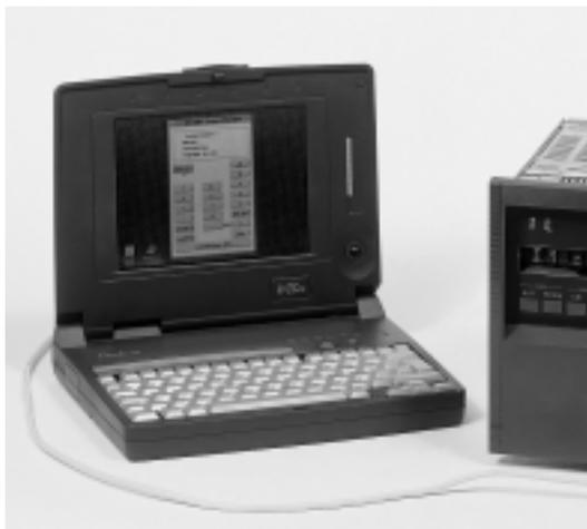
Exemple d'utilisation du logiciel SFT 2801 avec un Sepam 2000.
