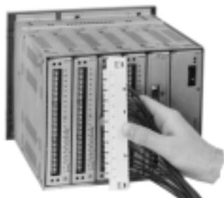
Les raccordements du Sepam 2000 sont faits sur des connecteurs amovibles situés sur la face arrière.
