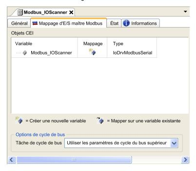
Le paramètre **Tâche de cycle de bus** vous permet de sélectionner la tâche d'application qui gère le scrutateur :
