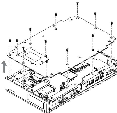
4. Retirez la vis de la zone d'installation de la carte M.2 SSD sur le produit.
