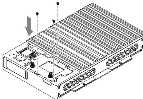
9. Placez le couvercle de l'interface optionnelle sur le Box Module.
