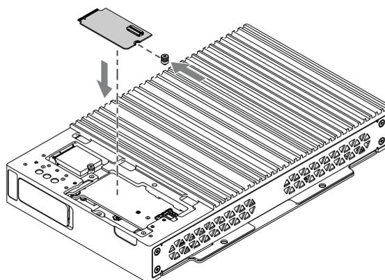
6. Insérez la carte Ethernet M.2 en diagonale dans l'emplacement prévu à cet effet sur le produit.
