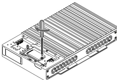
11. Placez le couvercle de l'interface optionnelle et serrez les vis.
