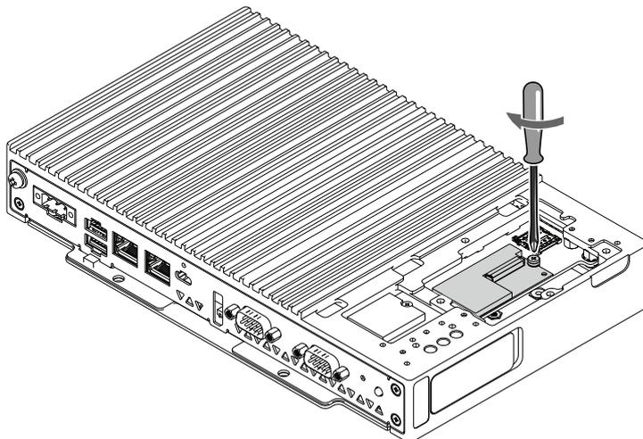
9. Connectez le câble du port du support du module RS-232C à la prise de la carte M.2 RS-232C.
