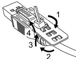
4. En enfonçant la poignée de l'attache, insérez le câble de l'étape 3 dans l'interface hôte USB. Assurez-vous que la languette de l'attache est fixée sur le câble USB branché sur le produit.
