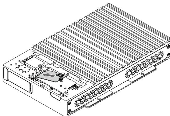
7. Poussez la carte Ethernet M.2 vers le bas et la serrez avec la vis M.2.
