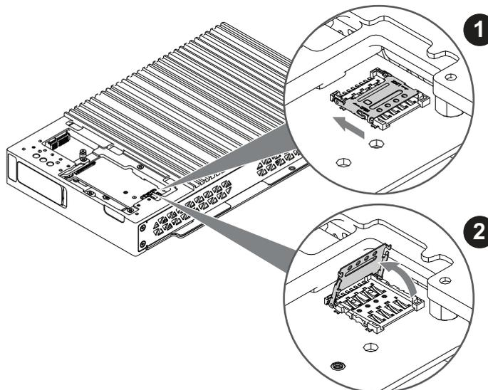
10. Insérez la carte SIM dans l'emplacement, puis fermez et faites glisser le couvercle dans le sens de la flèche pour le verrouiller.
