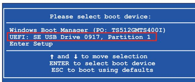
6. Si vous récupérez le système avec la clé USB de récupération en option, sélectionnez **OK**. Pour restaurer le système à l'aide d'une clé USB de récupération créée à l'aide de l'outil Recovery USB Creation Tool, sélectionnez **Restore > OK**.
