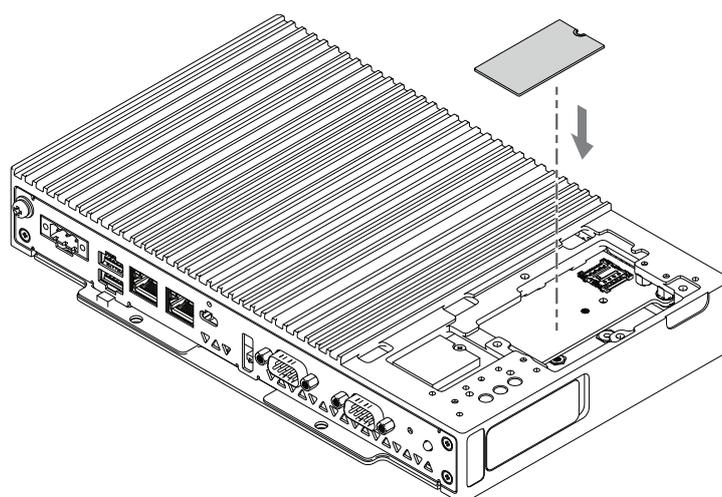
6. Insérez la vis M.2 dans l'emplacement de la carte M.2 RS-422/485.
