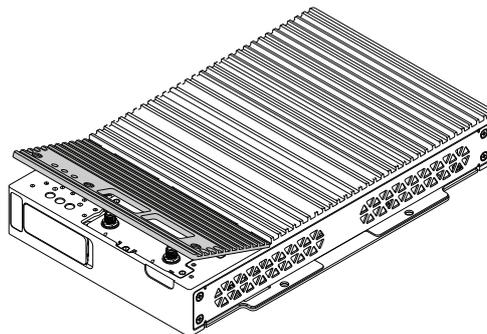
10. Fixez le couvercle de l'interface optionnelle sur le Box Module à l'aide des vis.
