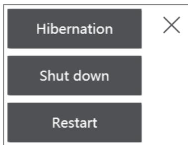
**NOTE:** Lorsque HORM est activé, l'utilisation de l'icône de mise en Hibernation pour mettre le système d'exploitation en veille prolongée remplacera l'état enregistré antérieurement dans HORM par l'état système actuel. Lorsque vous redémarrez le système, le système démarre dans l'état enregistré à la mise en veille prolongée. Après cela, même si HORM est activé, si l'alimentation est coupée, le système retourne à l'état enregistré à la mise en veille prolongée.
