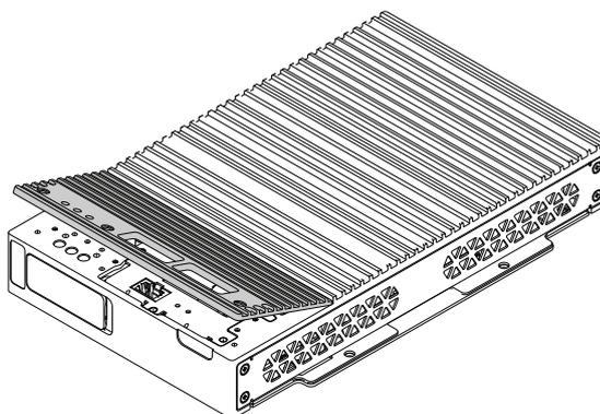
12. Fixez le couvercle de l'interface optionnelle sur le Box Module à l'aide des vis.
