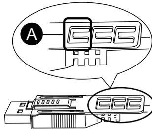
A. Passez l'attache à travers cet orifice.
