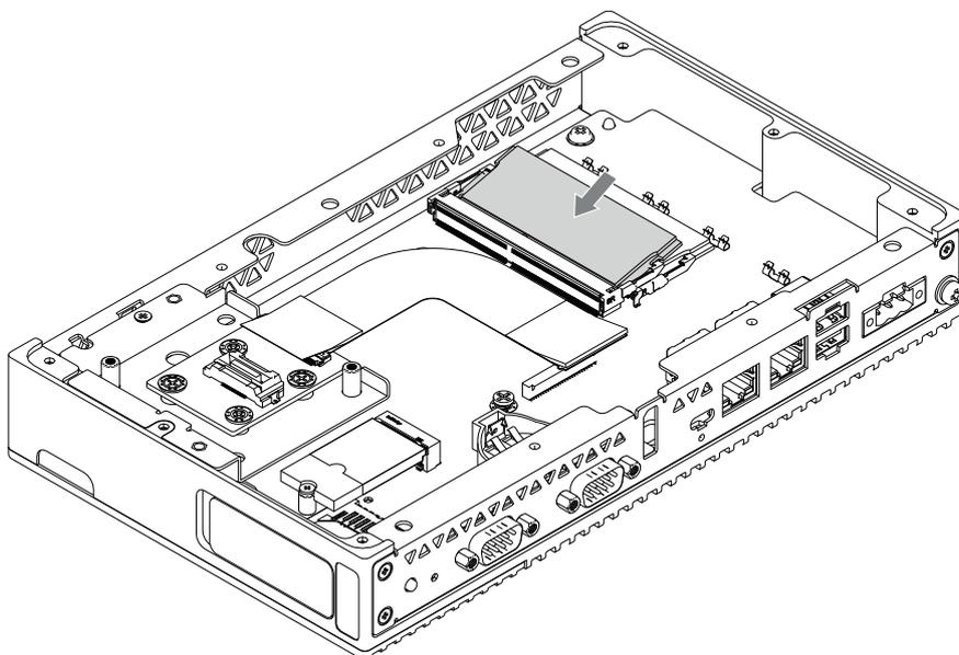
7. Poussez le module DIMM sur le produit, puis le module DIMM est verrouillé.
