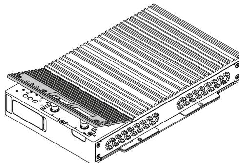
15. Fixez le couvercle de l'interface optionnelle sur le Box Module à l'aide des vis.
