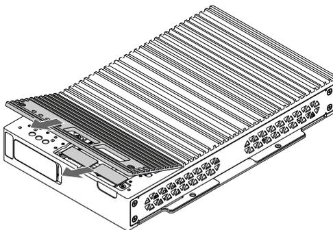
6. Retirez le film protecteur de la surface supérieure et de la surface inférieure du dissipateur thermique.
