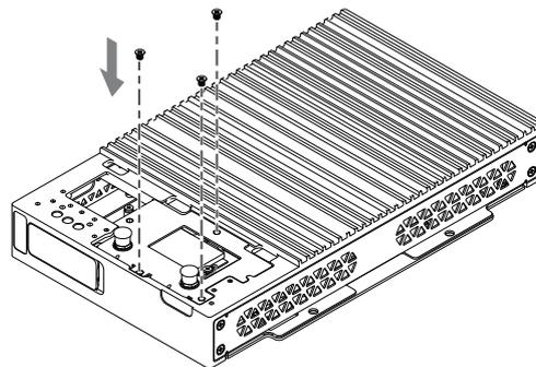
14. Placez le couvercle de l'interface optionnelle sur le Box Module.
