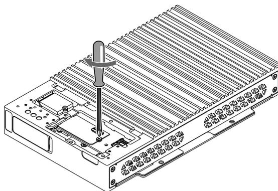
8. Placez le support du module Ethernet sur le produit.
