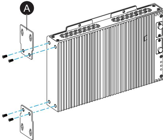
3. Montez le produit au panneau ou au mur avec les vis M4 (4 pièces).
