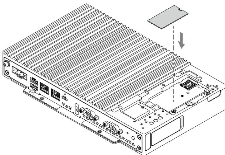
6. Insérez la vis M.2 dans l'emplacement de la carte RS-232C M.2.
