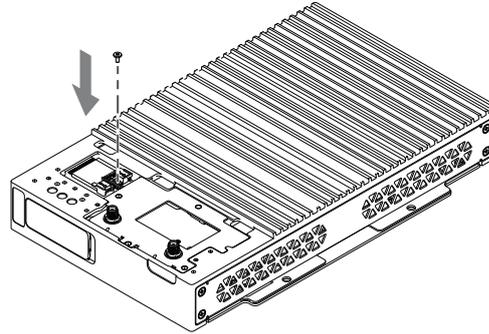
8. Fixez le support du module WiFi/Bluetooth sur le produit et serrez-le avec des vis M3.
