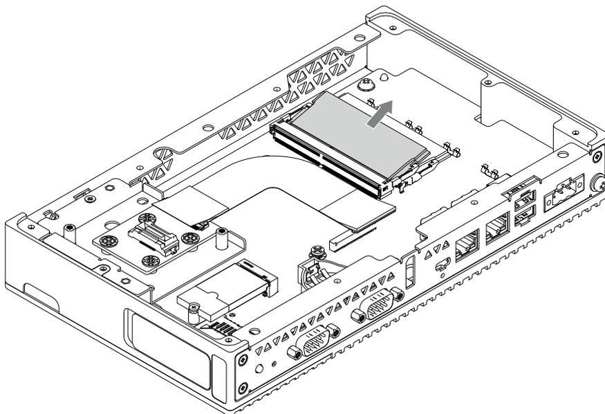
6. Insérez le module DIMM dans le produit.
