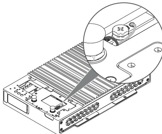
13. Fixez le support du module 4G sur le produit et serrez-le avec des vis M3.
