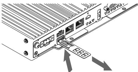
**NOTE:** Pour USB Type C, retirez le câble USB en appuyant sur la section de poignée de l'attache.
