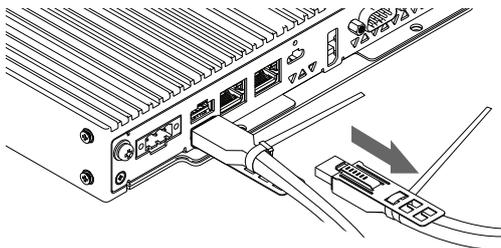
2. Desserrez l'attache du câble de la pince USB dans le port inférieur.
