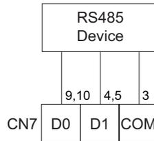
**Remote On and Off / Télécommande marche/arrêt / Ferngesteuertes Ein- und Ausschalten / Encendido y apagado a distancia / Remote Accensione e spegnimento a distanza / 远程开和关**
