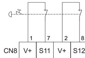
**External Protective Stop / Arrêt de protection externe / Externe Schutzabschaltung / Parada protectora externa / Arresto di protezione esterno / 外部保护停止**
