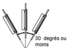
Lorsque le panneau est installé dans une position ayant une inclinaison dépassant 30°, la température ambiante ne doit pas dépasser 40 °C (104 °F). Vous pouvez utiliser un dispositif de refroidissement de l'air (ventilateur, climatiseur) pour vous assurer que la température de fonctionnement ne dépasse pas 40 °C (104 °F).
