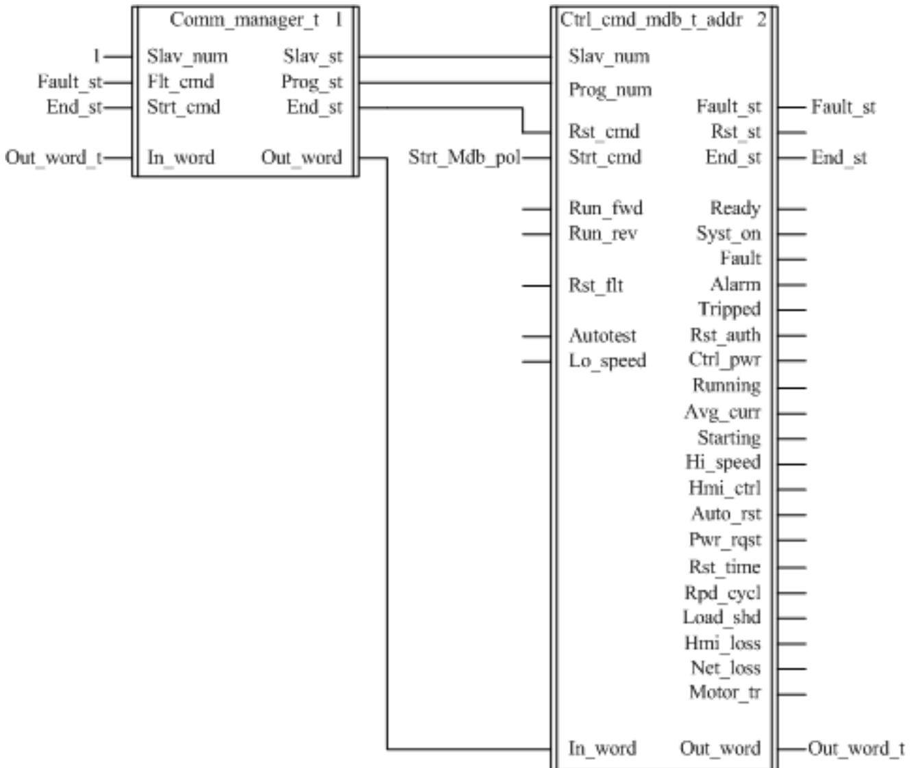
Le DFB `Comm_manager_t` peut être utilisé avec les démarreurs-contrôleurs TeSys U et les contrôleurs de gestion de moteur TeSys T présents sur le même réseau Modbus (liaison série).
