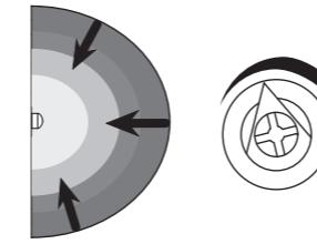
**Réglage de la luminosité de détection**
