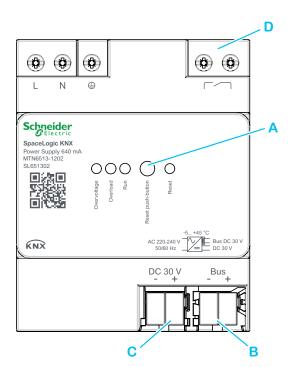
La ligne de bus peut être raccordée à l'alimentation KNX au niveau de la connexion **B** « Bus ». En raison de l'inductance intégrée, l'utilisation d'une inductance KNX externe n'est pas nécessaire.
