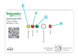
Surtension LED allumée : surtension sur la ligne de bus KNX et à la sortie CC 30 V
