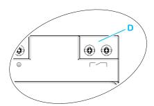
L'alimentation KNX comporte une sortie de relais sans potentiel **D** qui fonctionne comme un contact de signalisation pour les messages de fonctionnement ou de diagnostic. Ce contact est fermé en cas de fonctionnement normal et ouvert en cas de dysfonctionnement des appareils (surcharge, surtension, coupure de tension KNX).Fonction du contact de signalisation --> 12
