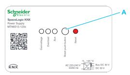
Appuyer sur le bouton de réinitialisation **A** pour réinitialiser la ligne de bus raccordée ou acquitter un défaut.
