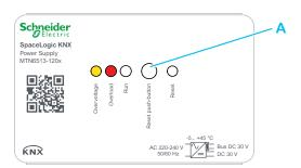
Appuyer sur le bouton de réinitialisation **A** pour réinitialiser la ligne de bus raccordée ou acquitter un défaut.
