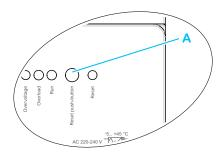
L'alimentation dispose d'un bouton de réinitialisation **A** qui, lorsqu'il est activé, court-circuite la ligne de bus pendant une durée définie ou de manière permanente, ce qui permet de réinitialiser les appareils de bus raccordés. Il est également possible d'acquitter un message de défaut via le bouton de réinitialisation. Réinitialisation de l'appareil --> 10
