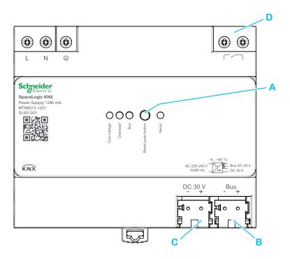
La ligne de bus peut être raccordée à l'alimentation KNX au niveau de la connexion **B** « Bus ». En raison de l'inductance intégrée, l'utilisation d'une inductance KNX externe n'est pas nécessaire.
